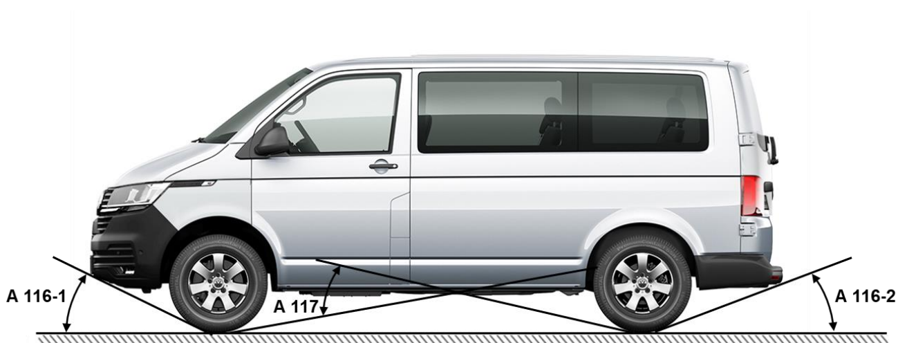
Rys. 1 Przykładowy kąt nachylenia zbocza i kąt rampowy dla modelu Transporter w wersji furgon/kombi, rozstaw osi krótki/długi (zgodnie z DIN70020, T1)
