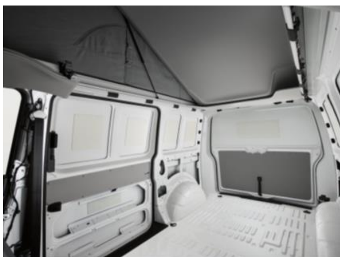
Rys. 1 i 2: Podnoszony dach z dużym wycięciem w dachu
