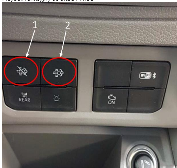
Rys. 1: Przycisk regeneracji postojowej (przedstawienie zasady)
