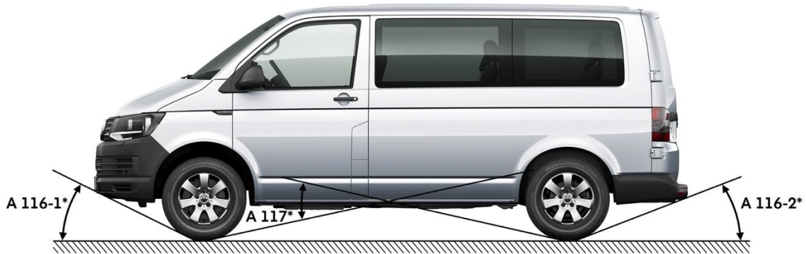
Rys. 1 Kąt natarcia i kąt rampowy – Transporter furgon / kombi
