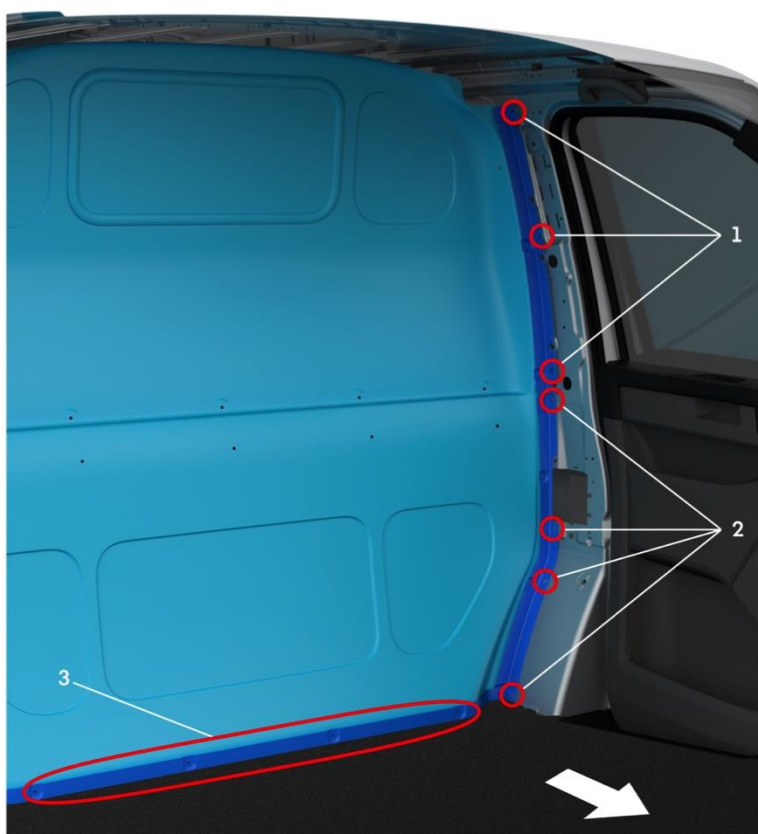
Rys. 2: Punkty mocowania seryjnej ścianki oddzielającej – widok przestrzeni kierowcy z lewej strony (strzałka wskazuje kierunek jazdy!)
