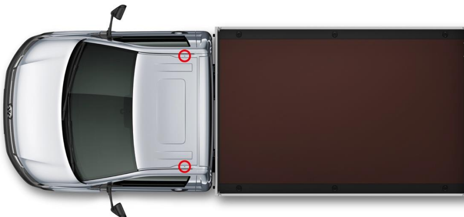
Rys. 3: Seryjne punkty mocowania w dachu w samochodzie z kabiną pojedynczą
