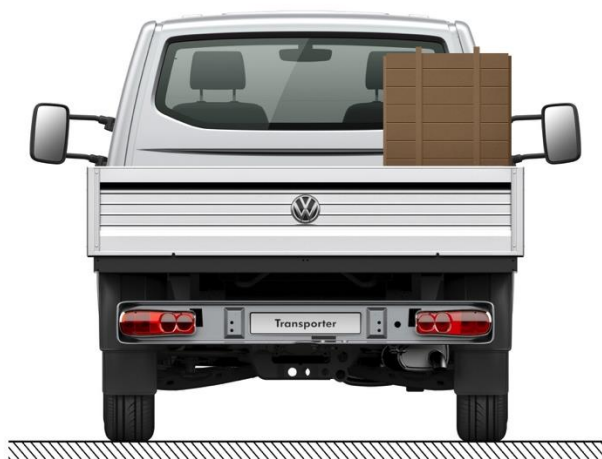
Rys. 1: Jednostronne rozłożenie ciężaru (widok z tyłu)
