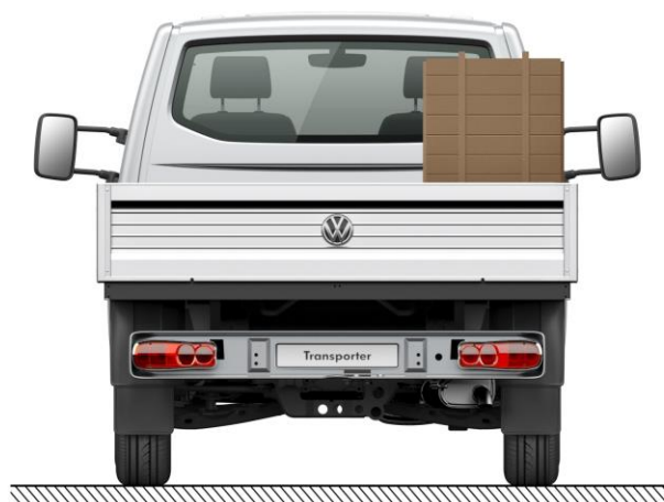
Fig. 1: Distribuzione non uniforme del peso (vista posteriore)
