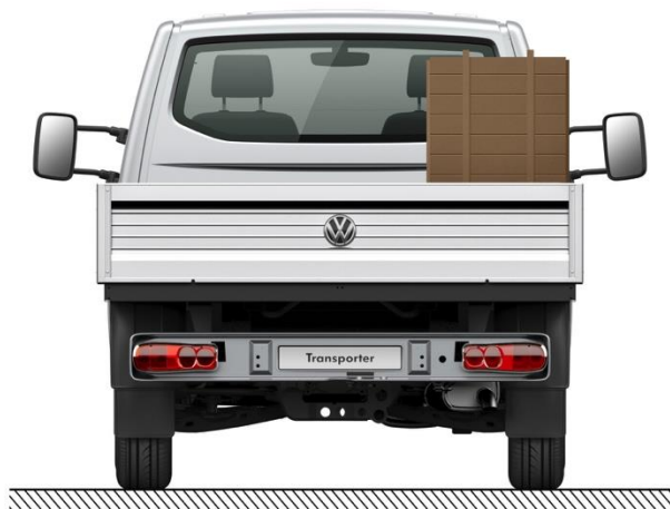
Рис. 1.: Одностороннее распределение нагрузки (вид сзади)
