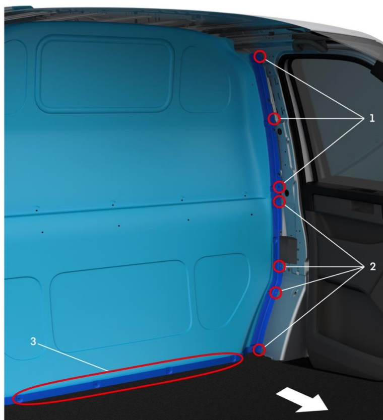
Рис. 2: Точки крепления для серийной перегородки – вид: кабина водителя, левая сторона (стрелка показывает в направлении движения!)
