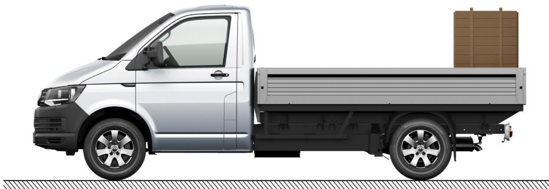
Рис. 2: Одностороннее распределение нагрузки (вид сбоку)
