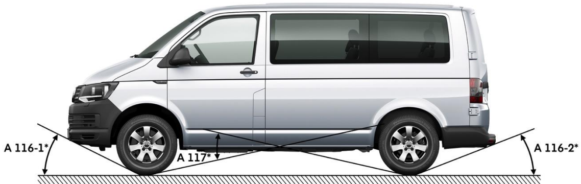
Abb. 1 Überhang- und Rampenwinkel Transporter Kasten / Kombi
