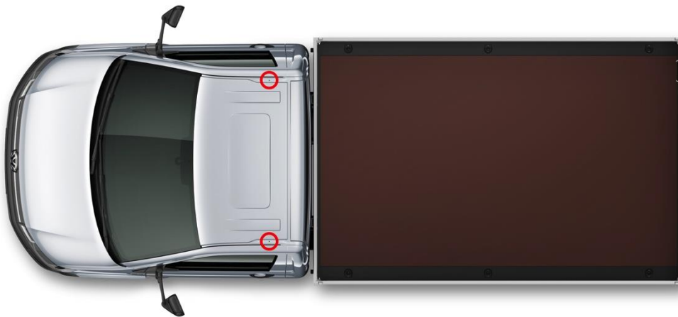
Abb.3: Serienmäßige Dachbefestigungspunkte Einzelkabine
