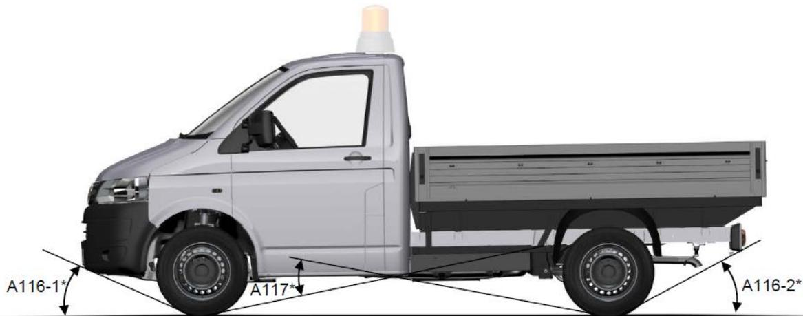
Fig. 2: Ángulos de voladizo y ángulo de paso por cresta Transporter Plataforma/Chasis
