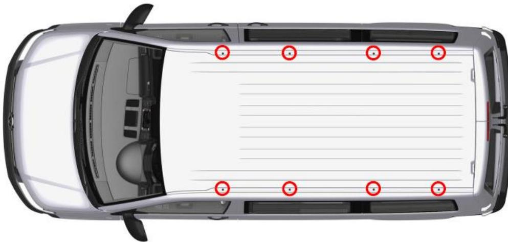
Fig. 1: Puntos de fijación de serie en el techo Furgón y Kombi (batalla corta)
