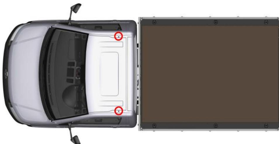
Fig. 3: Puntos de fijación de serie en el techo vehículo de Plataforma
