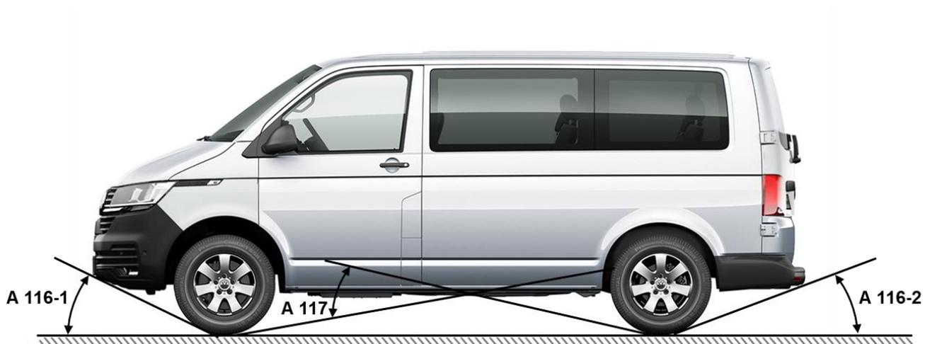
Fig. 1: Angolo di sbalzo e angolo di rampa a titolo di esempio per Transporter furgone / Kombi, passo corto/lungo (secondo DIN70020, T1)
