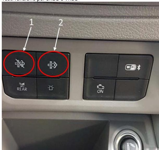
Fig 1: tasto rigenerazione a veicolo fermo (esempio)
