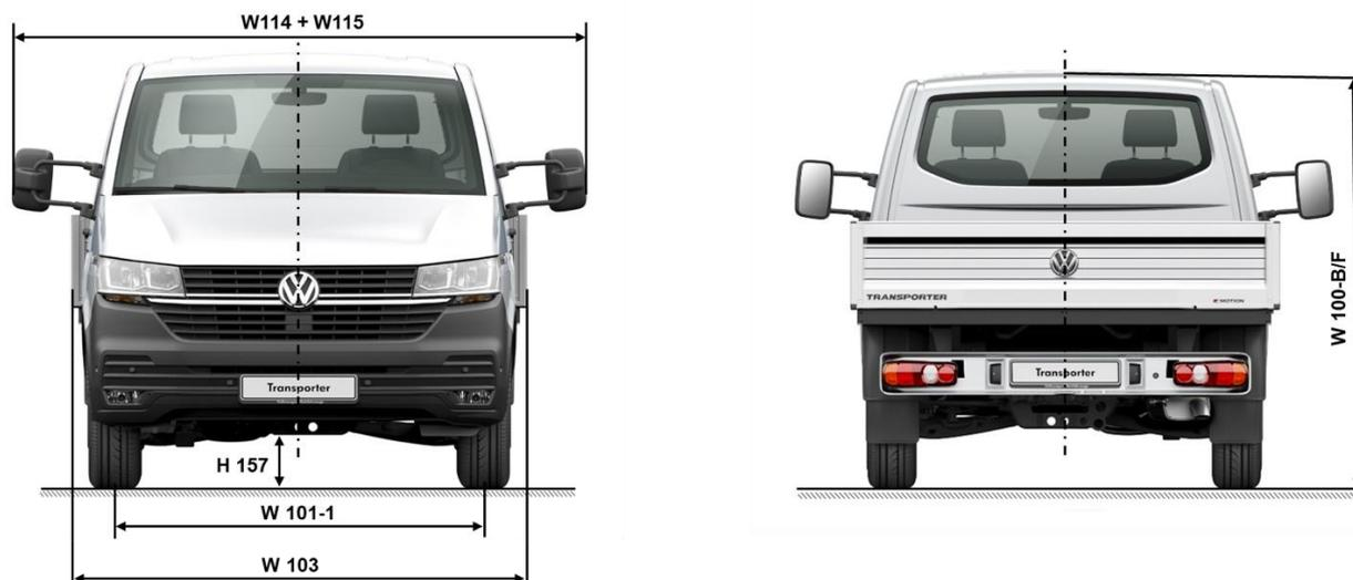
Fig. 5: Dimensioni del veicolo a titolo di esempio per camioncino a passo corto/lungo (secondo DIN70020, T1)
