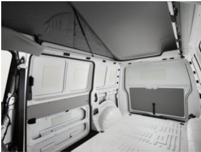
Fig. 1 y 2: Techo levadizo con hueco grande en el techo
