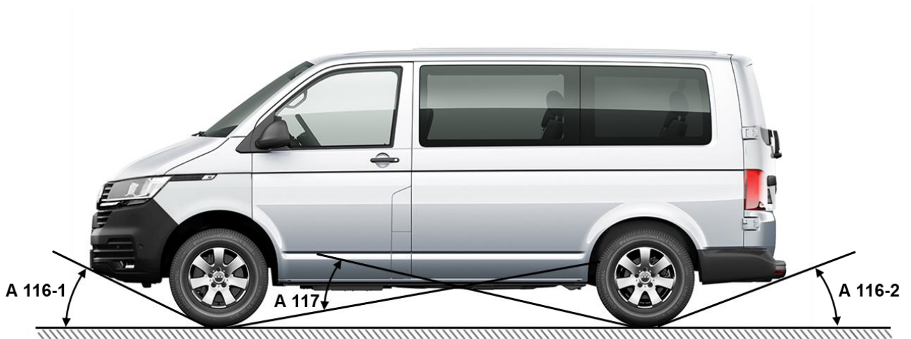
Fig. 1: Ángulo de voladizo y ángulo de paso por cresta Transporter Furgón/Kombi, a título de ejemplo, batalla corta/larga (según DIN70020, T1)
