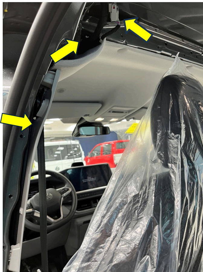
Abb. 1: Verkleidung B-Säule und Dachverkleidung ohne Trennwand
