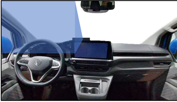
Abb. 1: Position und Sichtfeld der Multifunktionsinnenraumkamera
