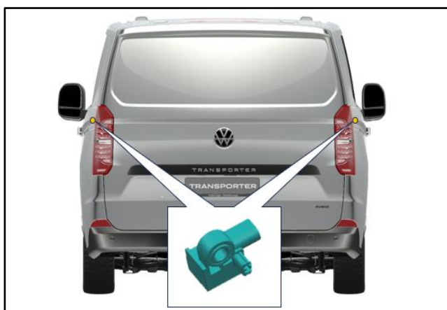
Czujniki w słupku D
