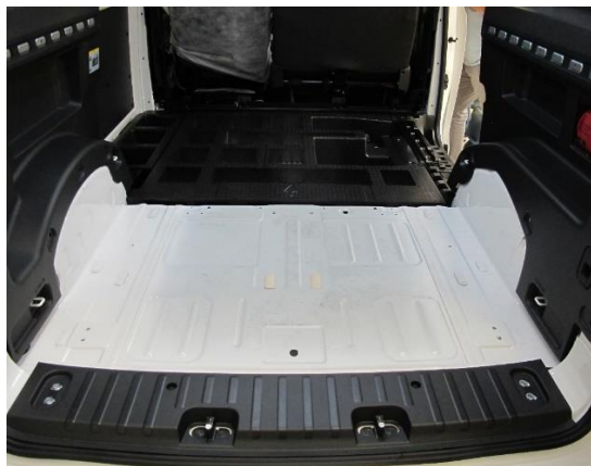
Rys. 3: Widok punktów mocowania i punktów mocowania śrubowego
