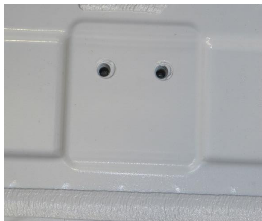
Rys. 4: Punkty mocowania śrubowego w podłodze pojazdu
