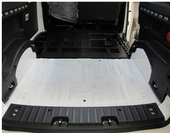
Fig. 3: Vista puntos de amarre y puntos de atornillamiento
