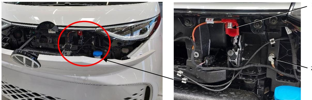
Fig. 1: Conexión para carga auxiliar
