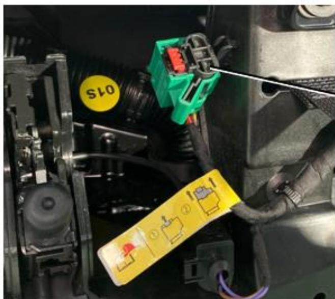
Conector de mantenimiento Service Disconnect
