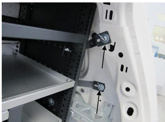
Fig. 5: Representación gráfica, vista de una unión atornillada en la chapa interior con placa maciza insertada
