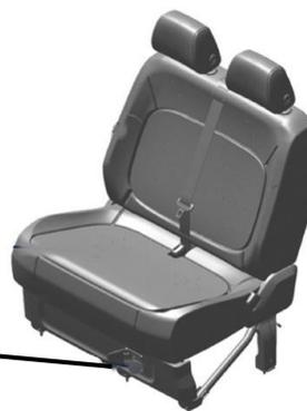
Fig. 2: Ubicación de la toma de corriente interior de 230 V en el asiento de dos plazas para acompañantes
