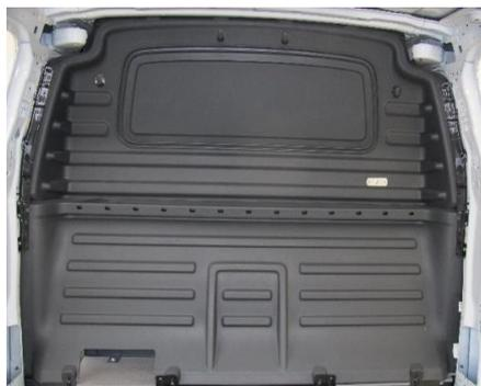
Fig. 1: Panel de separación
