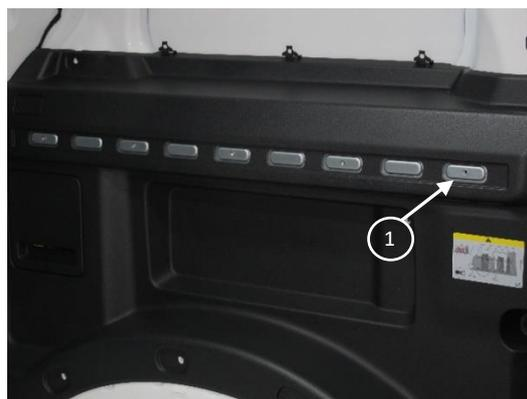
Fig. 4 : surface de vissage sur le renfort
