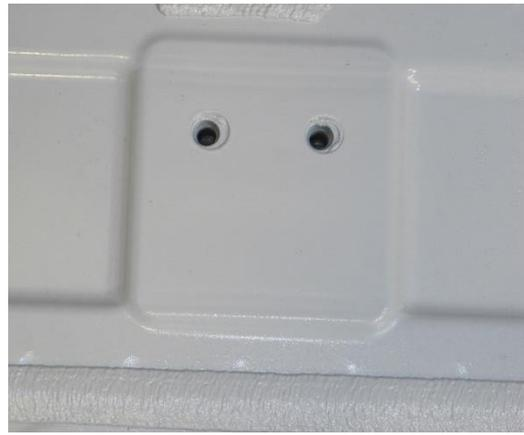
Fig. 4 : points de vissage dans le plancher du véhicule
