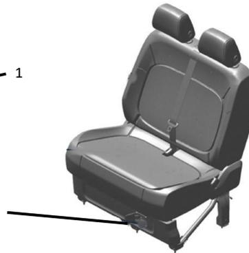
Fig. 2 : position de la prise intérieure 230 V sur une banquette passager double
