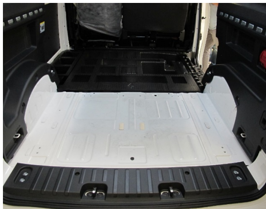
Abb. 3: Ansicht Zurrpunkte und Verschraubungspunkte
