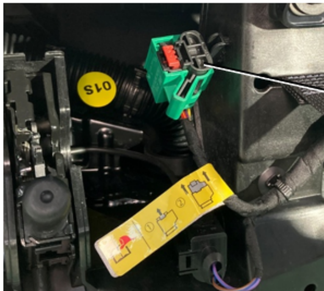
Abb. 2: Wartungsstecker am Schlossträger vorn rechts
