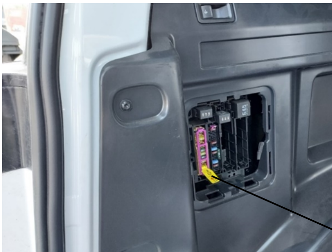
Abb. 1: Position des Sicherungsträgers D im Laderaum links hinter der Verkleidung
