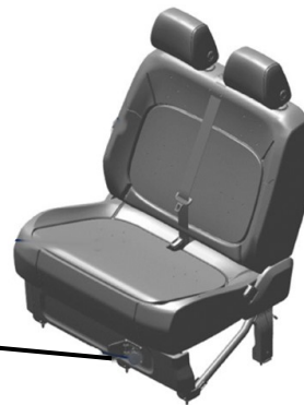
Abb. 2: Lage der Innensteckdose 230V bei einer Doppelbeifahrerbank
