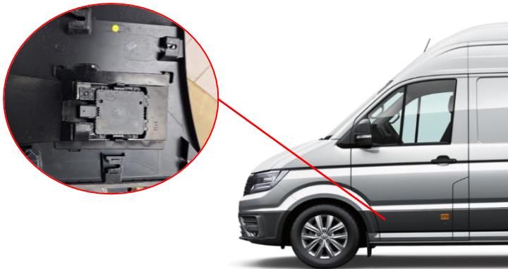
Rys. 3: Umiejscowienie czujników radarowych w drzwiach
