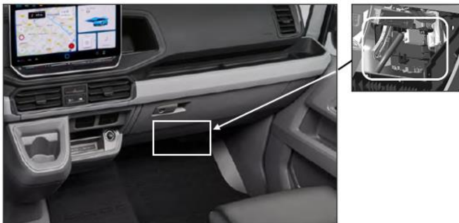
Miejsce montażu KFG w dolnej części deski rozdzielczej, za przednim schowkiem.
