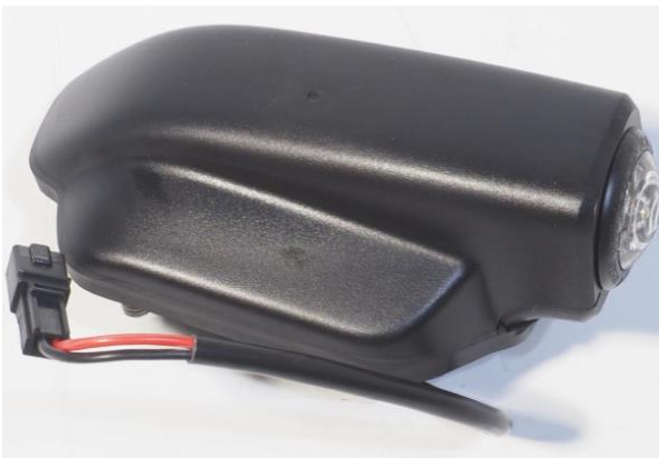
Rys. 3: Światło pozycyjne prawe i lewe, numer części: 7C0 941 061 C
