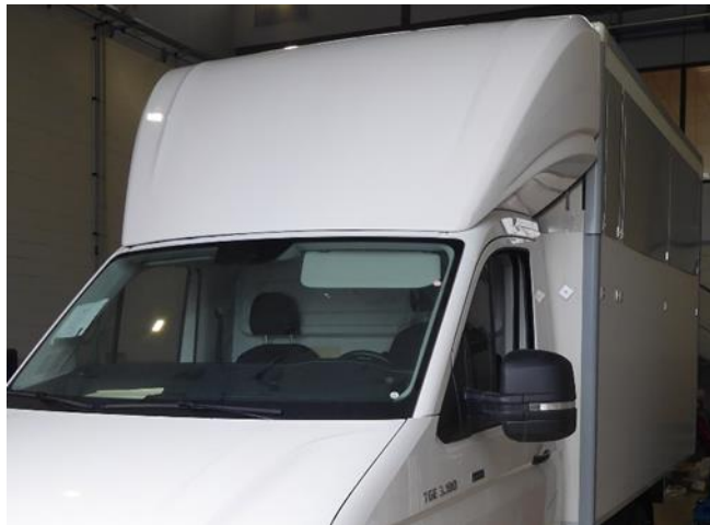
Rys. 1: Owiewki dachowe/spoiler dachowy na kabinie pojedynczej (rysunek poglądowy)
