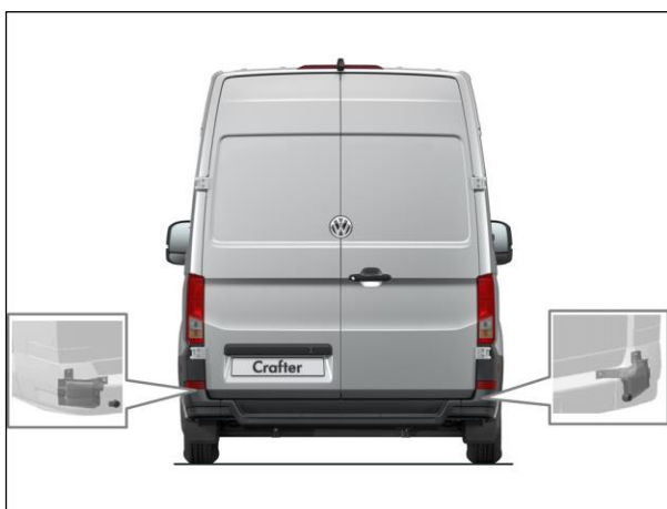
Rys. 3: Umiejscowienie czujników radarowych za pokrywą zderzaka z lewej i prawej strony
