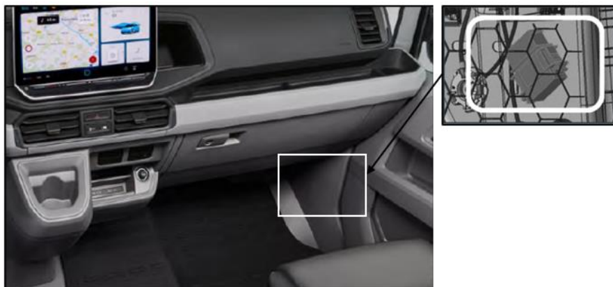
Listwa zaciskowa (IS1) za okładziną słupków A, na dole
