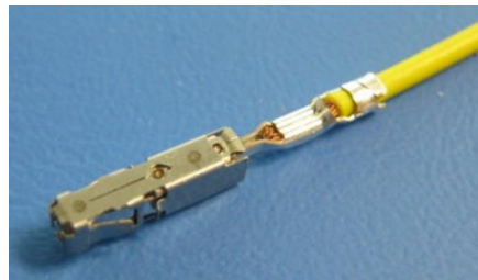
Rys. 6: Przeciwwtyczka „Przygotowanie punktu sprzęgu obrotowych świateł ostrzegawczych” z pojedynczym kablem i stykami
