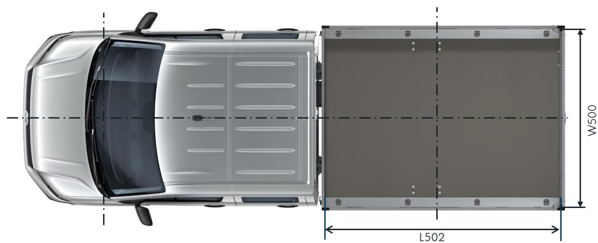
Rys. 2: Wymiary pojazdu z podwójną kabiną – pojazdy skrzyniowe/widok z dachu
