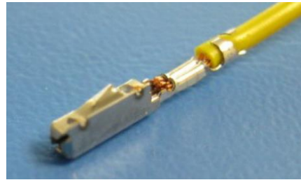
Rys. 4: Przeciwwtyczka dla światła pozycyjnego, numer części: 8W0 971 832 i zestaw pojedynczych kabli ze stykami, numer części: 000 979 009 E
