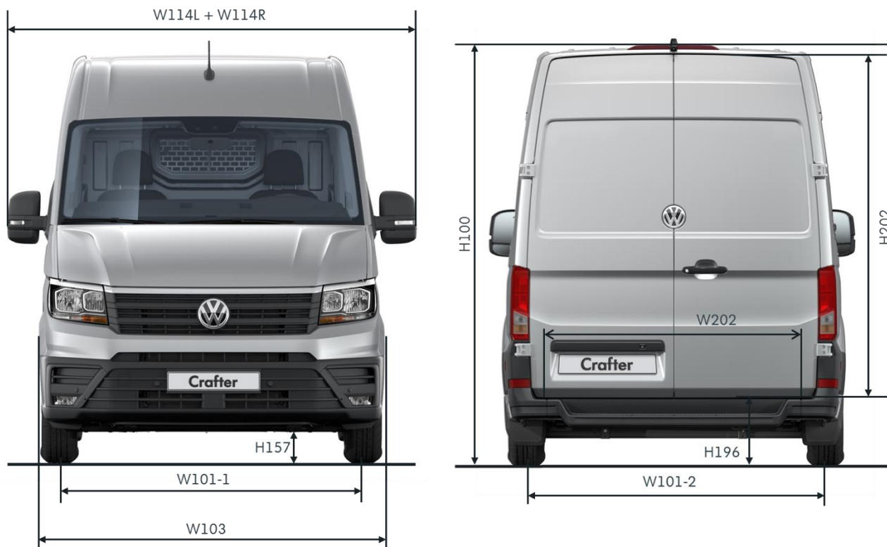
Rys. 3: Wymiary pojazdu – furgon / widok z przodu i tyłu
