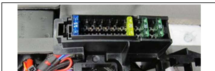
Szczegół A: uchwyt zabezpieczający – punkt poboru dla akumulatora pomocniczego
