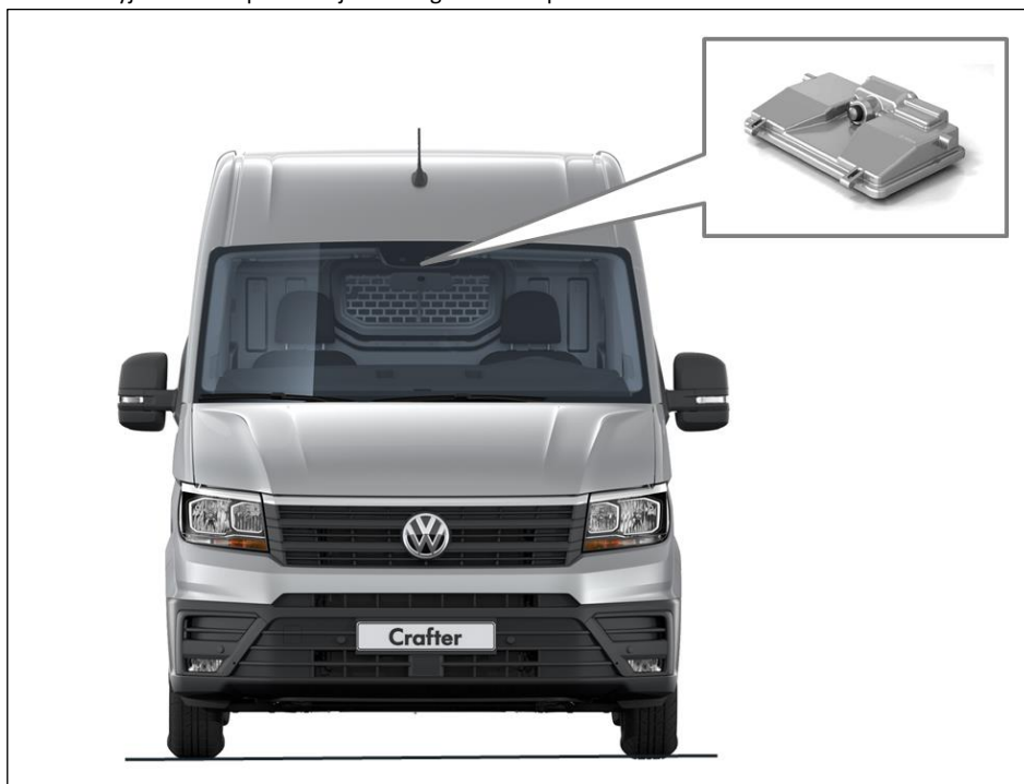
Rys. 1: Umieszczenie wielofunkcyjnej kamery w pojeździe
