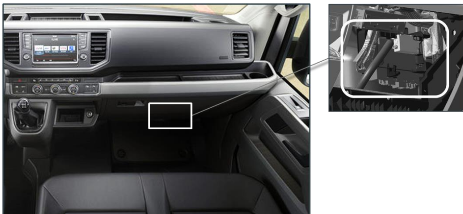
Miejsce montażu dopasowanego do klienta sterownika działania na desce rozdzielczej po prawej stronie
