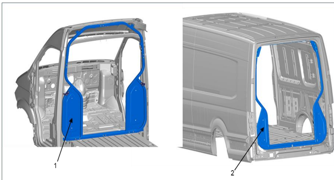
Rys. 1: Pałąk ochronny (nr PR 2Y1)
