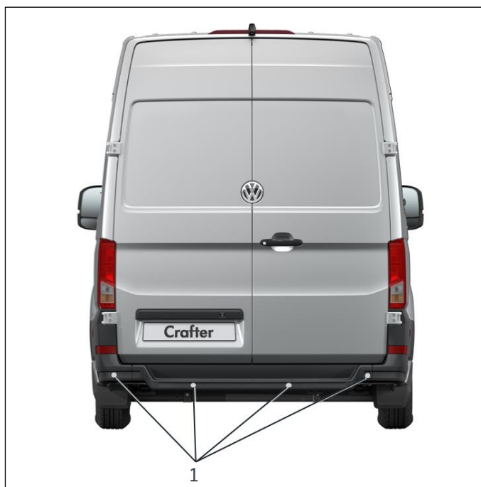
Rys. 1: Pozycja czujników ultradźwiękowych
