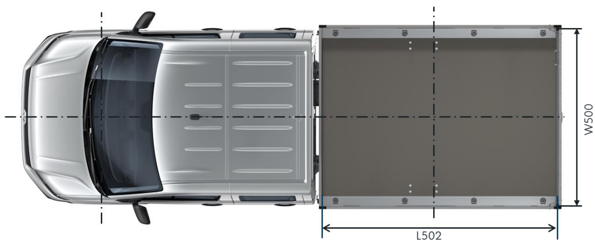
Rys. 2: Wymiary pojazdu z podwójną kabiną – samochody skrzyniowe/widok z dachu
