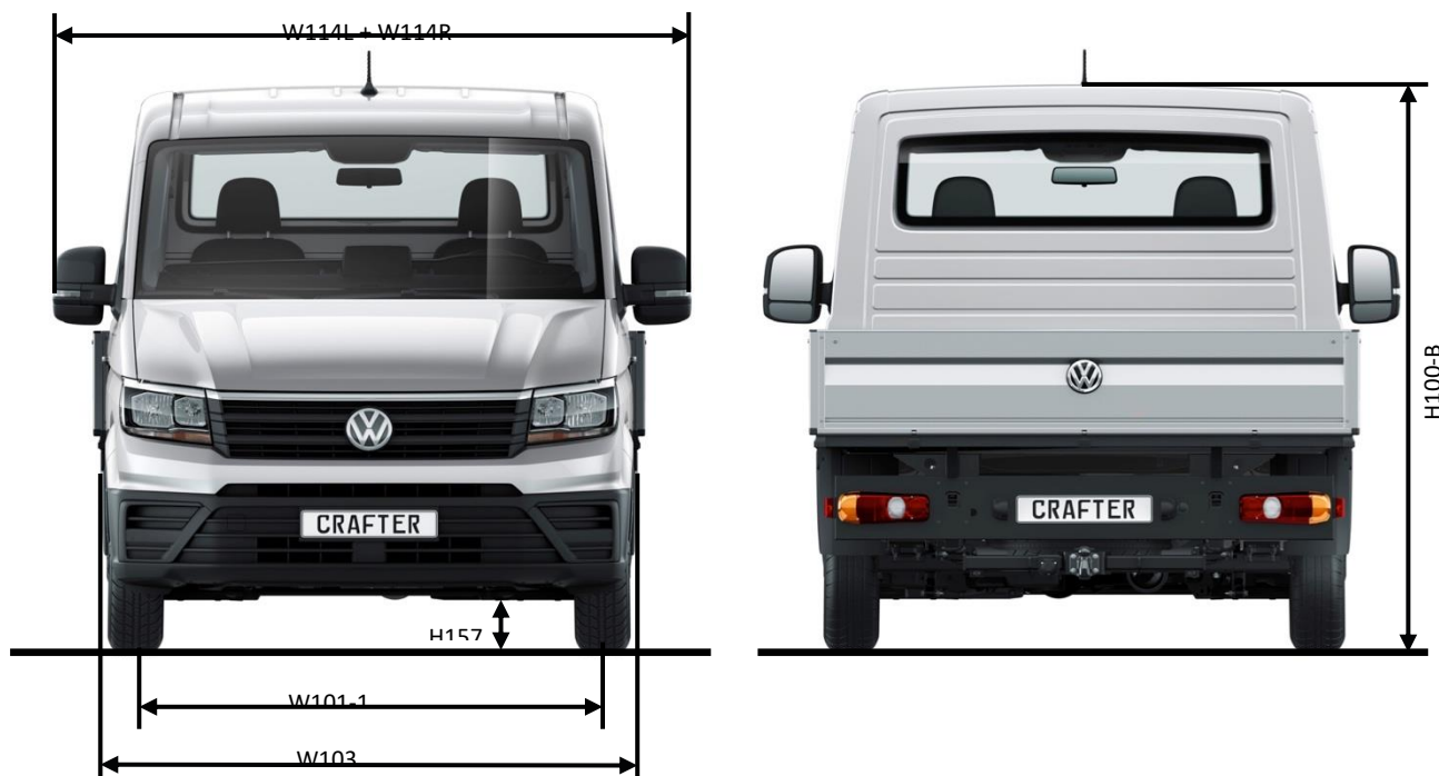
Rys. 3: Wymiary pojazdu z pojedynczą kabiną – samochody skrzyniowe/widok z przodu i tyłu
