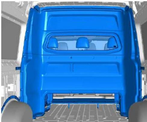
Fig. 2: esempio di smontaggio su un furgone con divano a tre/quattro posti nella 2ª fila (vista posteriore)
