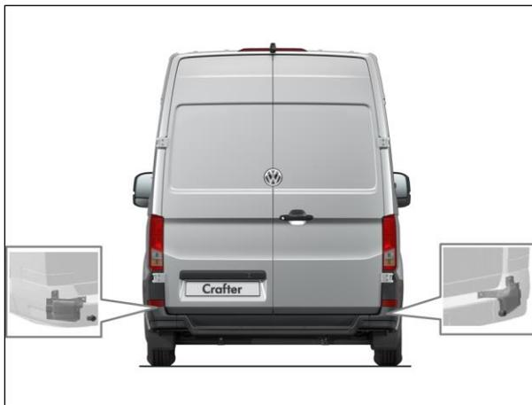
Fig. 3: posizione dei sensori radar dietro la copertura del paraurti, a sinistra e a destra
