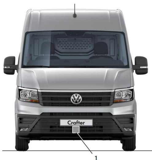
Fig. 1: radar anteriore
