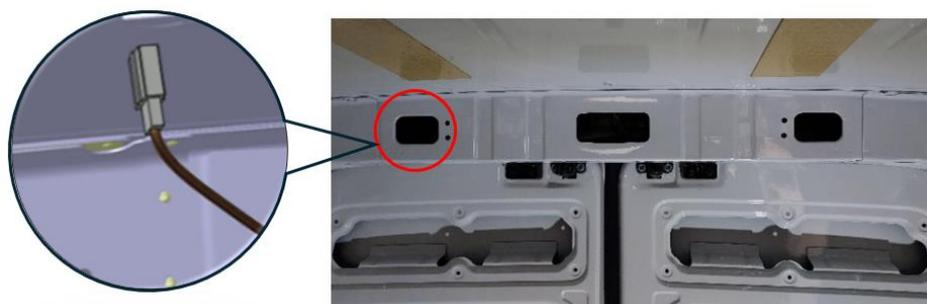
Fig. 2: punto di connessione posteriore, traversa terminale del tetto
