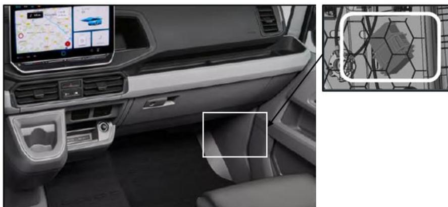
Morsettiera (IS1) dietro il rivestimento inferiore del montante A
