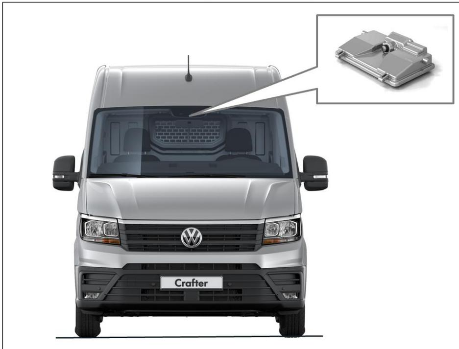
Fig. 1: posizione della telecamera multifunzionale nel veicolo
