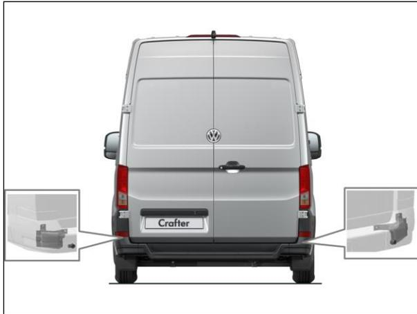
Fig. 1: posizione dei sensori radar nel paraurti posteriore
