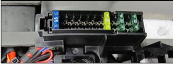
Fig. 3: dettaglio A - supporto fusibili, punto di prelievo per la seconda batteria
