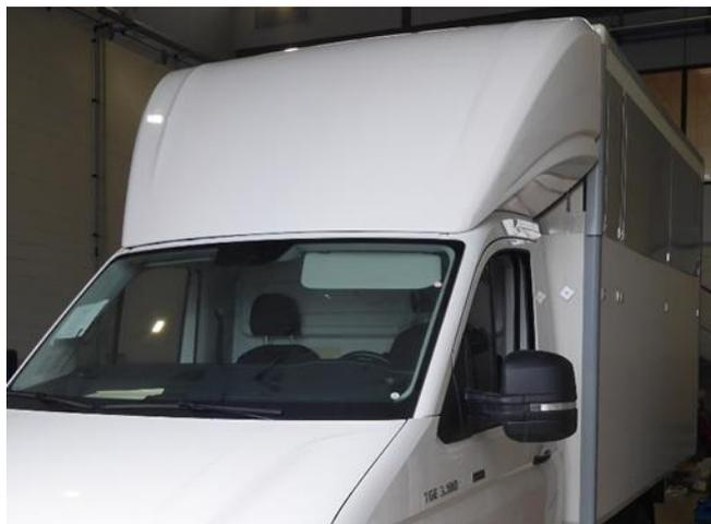
Fig. 1: deflettore / spoiler del tetto sulla cabina singola (esempio)
