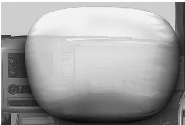
Fig. 2: zona di espansione dell'airbag del passeggero (immagini in fase di elaborazione!)
