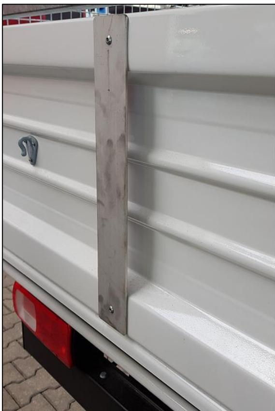
Fig. 3: striscia metallica sulla sponda posteriore
