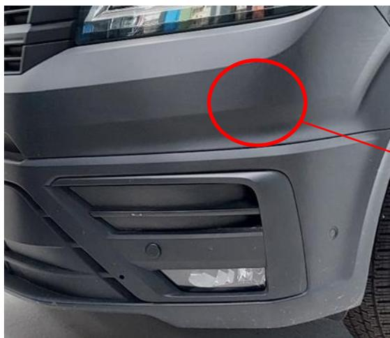
Fig. 3: posizione dei sensori radar dietro la copertura del paraurti anteriore
