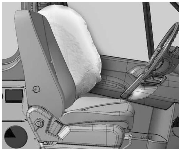
Fig. 1: zona di espansione dell'airbag per il torace, lato sinistro del veicolo (esempio!)
