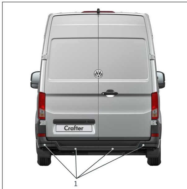
Fig. 2: Posición de los sensores de ultrasonido
