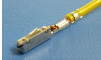
Fig. 4: Contraconector para luz de posición (número de pieza: 8W0 971 832) y juego de cables individuales con contactos (número de pieza: 000 979 009 E)
