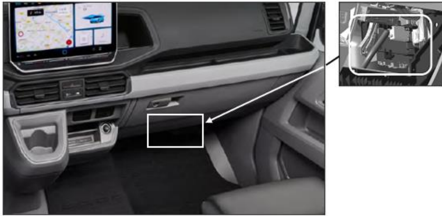
Posición de instalación de la UCFC en el tablero de instrumentos inferior, detrás de la guantera
