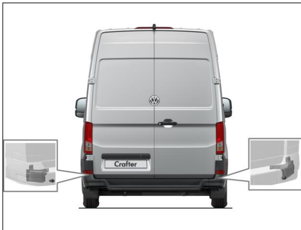
Fig. 3: Posición de los sensores de radar detrás del protector del paragolpes a izquierda y derecha
