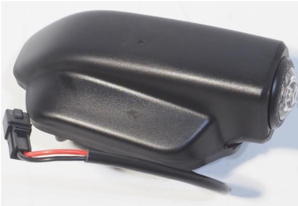
Fig. 3: Luz de posición derecha e izquierda (número de pieza: 7CO 941 061 C)
