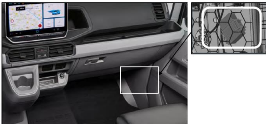
Regleta de terminales (IS1) detrás del guarnecido del pilar A en la parte inferior
