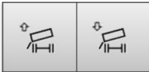
Fig. 2: Pulsador de mando en el vehículo (subir y bajar)
