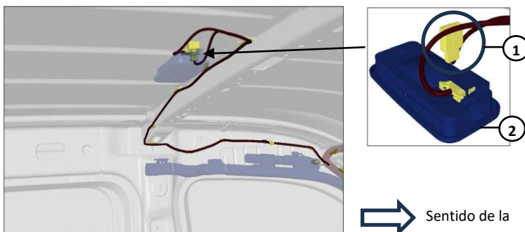
Fig. 4: Posición del punto de interconexión en el techo, para luz omnidireccional en cabina doble
