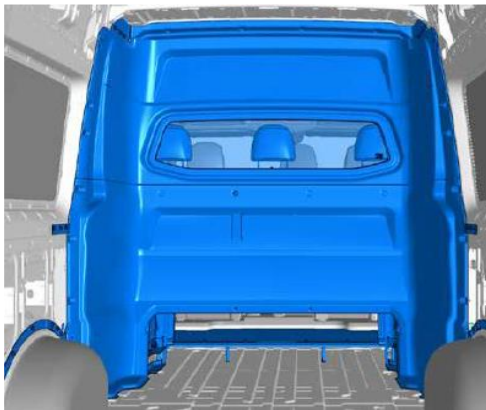
Fig. 2: Representación esquemática de ampliación de una furgoneta con banqueta de 3 plazas/banqueta de 4 plazas en la 2.ª fila de asientos Vista trasera
