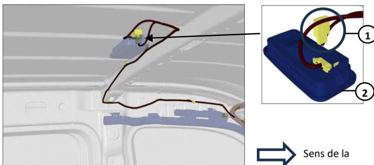
Fig. 4 : Position du point de couplage sur le pavillon, pour le gyrophare de la cabine double
