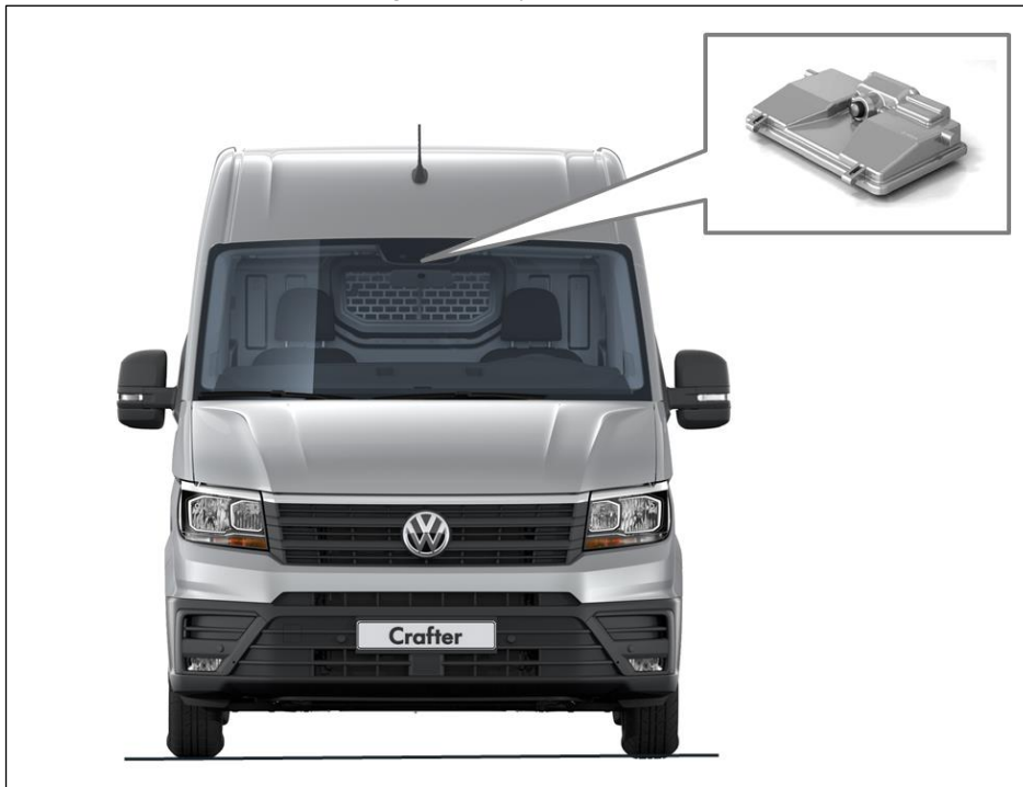
Fig. 1 : Position de la caméra multifonction dans le véhicule
