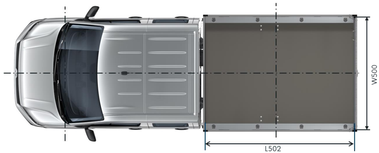
Fig. 2 : Cotes du véhicule à double cabine / Plateau / Vue du pavillon
