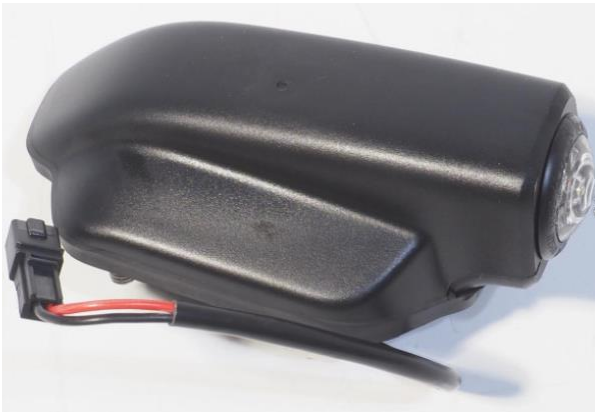
Fig. 3 : Feu de position droit et gauche, numéro de pièce : 7C0 941 061 C
