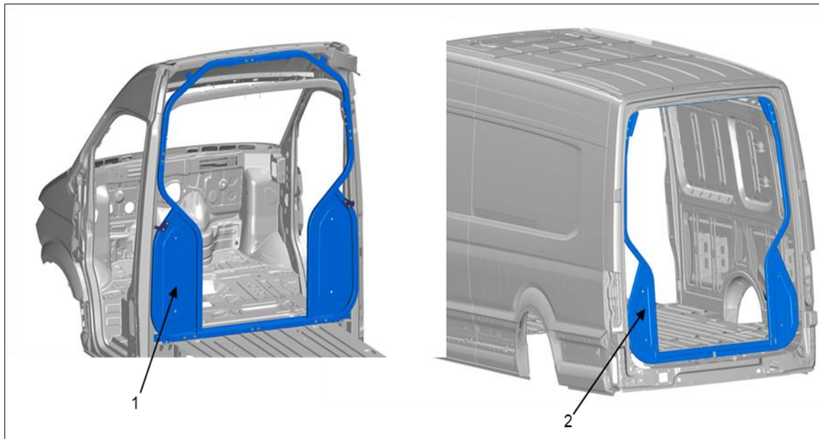
Fig. 1 : Arceau de sécurité (numéro PR 2Y1)
