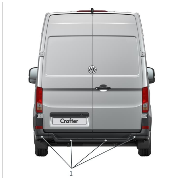
Fig. 2 : Position des capteurs à ultrasons
