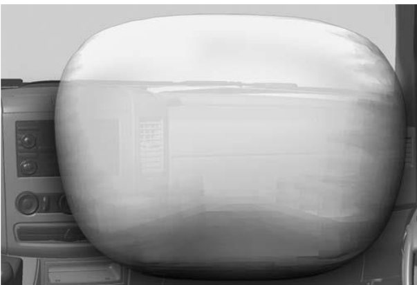
Fig. 2 : Zone de déploiement de l'airbag du passager avant (images en cours de traitement !)
