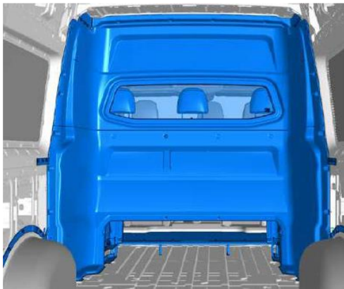
Fig. 2 : Schéma de principe pour un aménagement de fourgon tôlé avec banquette 3 / 4 places dans la 2e rangée de sièges. Vue de derrière.
