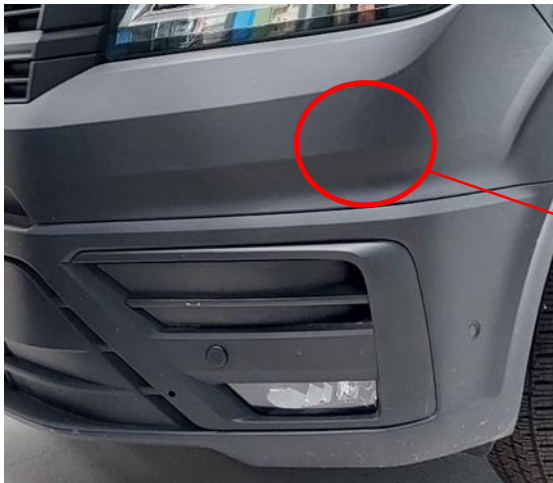
Fig. 3 : Emplacement des capteurs radar derrière le bouclier de pare-chocs avant
