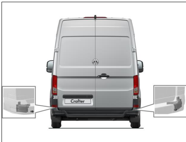
Fig. 3 : Emplacement des capteurs radar derrière le bouclier de pare-chocs à gauche et à droite
