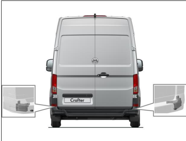
Fig. 1 : Position des capteurs radar dans le pare-chocs arrière
