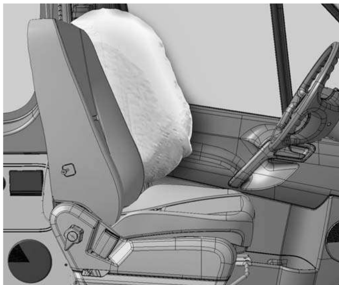
Зона раскрытия левой боковой подушки безопасности
