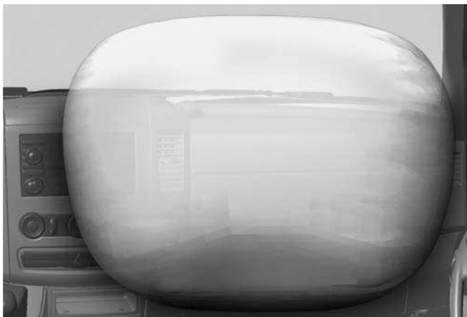
Зона раскрытия подушки безопасности переднего пассажира
