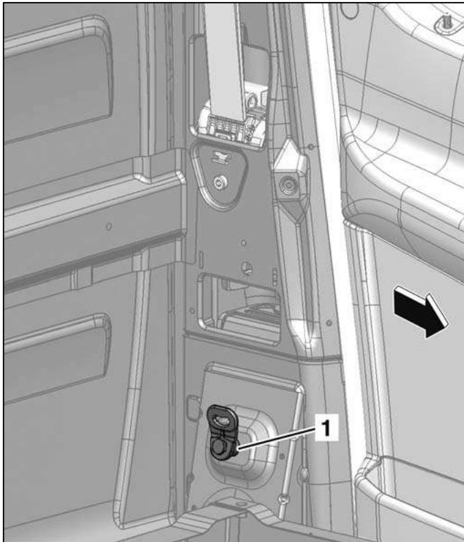
Aufnahmepunkt Gurtendbeschlag in B-Säule
