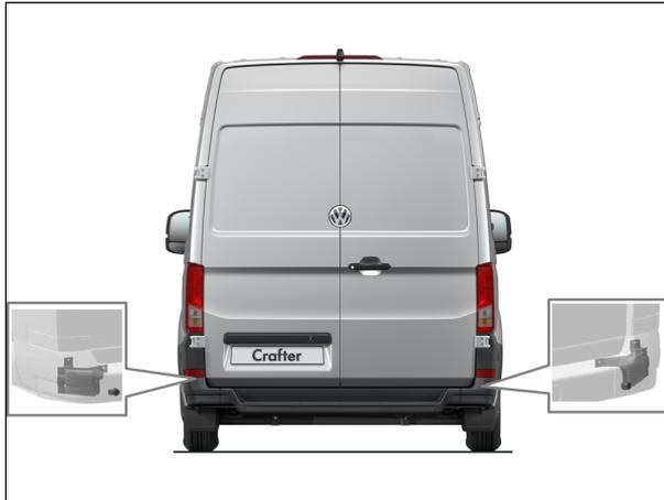
Fig. 1: Posición de los sensores de radar en el paragolpes trasero
