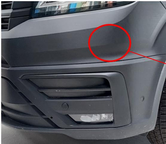
Fig. 3: Posición de los sensores de radar detrás de la cubierta del paragolpes delantero
