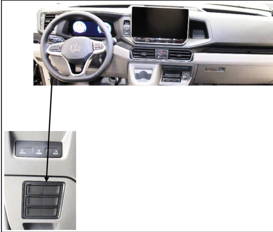
Fig. 1: 3x teclados de 2 pulsadores en la parte izquierda inferior, sin equipamientos adicionales
