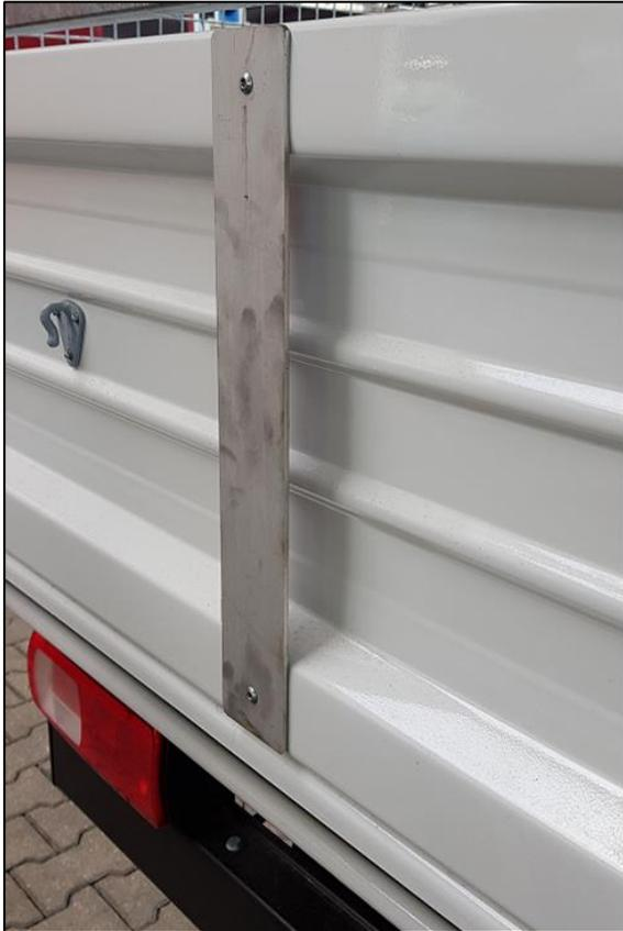
Fig. 3: Chapa igualadora en la pared trasera de la plataforma
