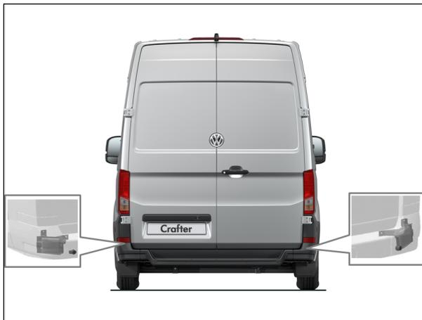
Fig. 3: Posición de los sensores de radar detrás de la cubierta del paragolpes a izquierda y derecha
