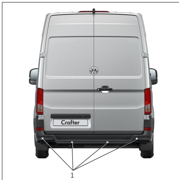
Fig. 2: Posición de los sensores de ultrasonido
