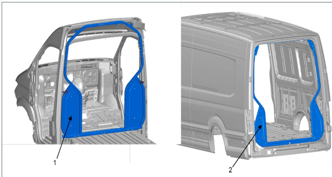
Fig. 1: Arco de protección antivuelco (núm. PR 2Y1)
