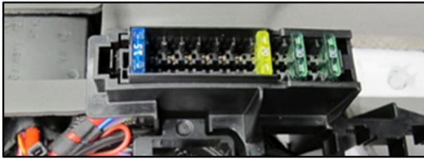
Fig. 3: Detalle A: portafusibles – terminal de toma de corriente para la segunda batería
