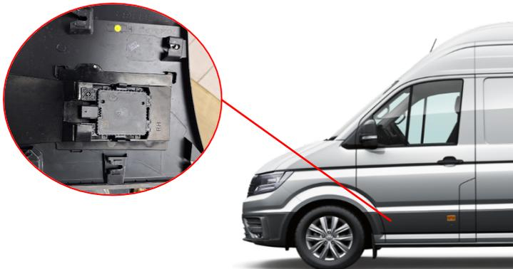
Fig. 3: Posición de los sensores de radar en la puerta
