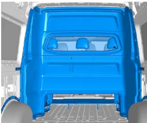
Fig. 2: Representación esquemática para una ampliación de furgoneta con banco de 3 plazas / banco de 4 plazas en la 2.ª fila de asientos. Vista por detrás.
