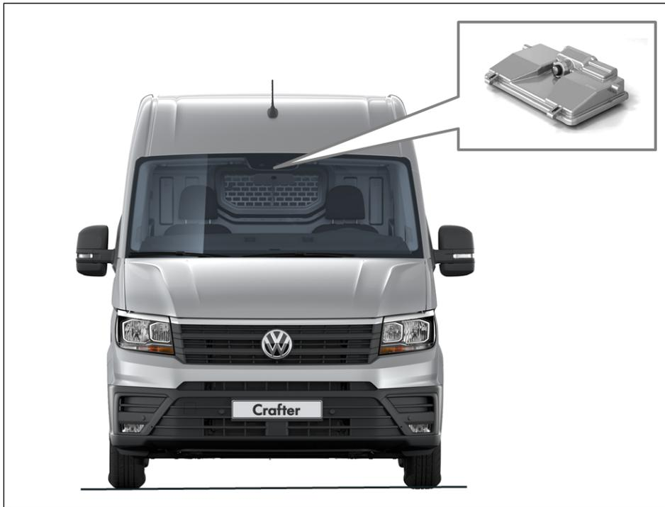
Fig. 1: Posición de la cámara multifunción en el vehículo
