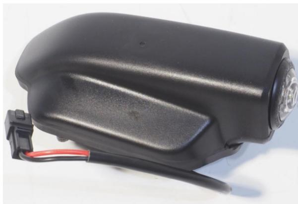
Fig. 3: Luz de posición derecha e izquierda, número de pieza 7C0 941 061 C
