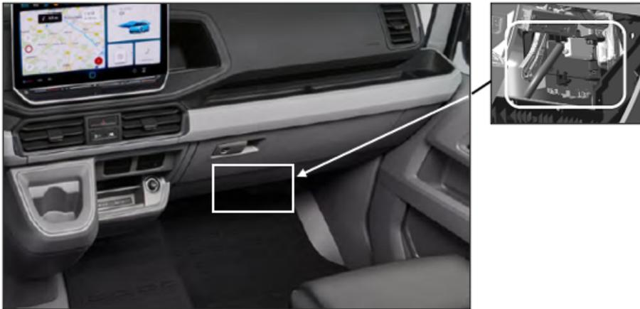
Posición de instalación de la UCFC en el tablero de instrumentos inferior, detrás de la guantera
