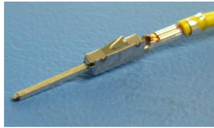
Fig. 5: Contraconector para conector de interconexión de la red de a bordo, número de pieza 8W0 972 575, y juego de cables individuales con contactos, número de pieza 000 979 012 E
