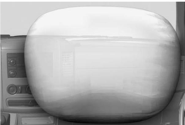
Fig. 2: Zona de despliegue del airbag del acompañante (¡representación esquemática!)
