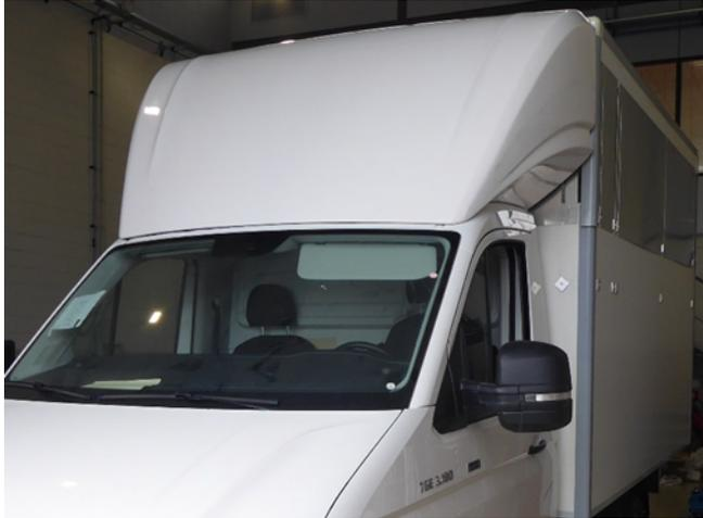
Fig. 1: Deflector de viento/espóiler del techo encima de la cabina simple (representación esquemática)
