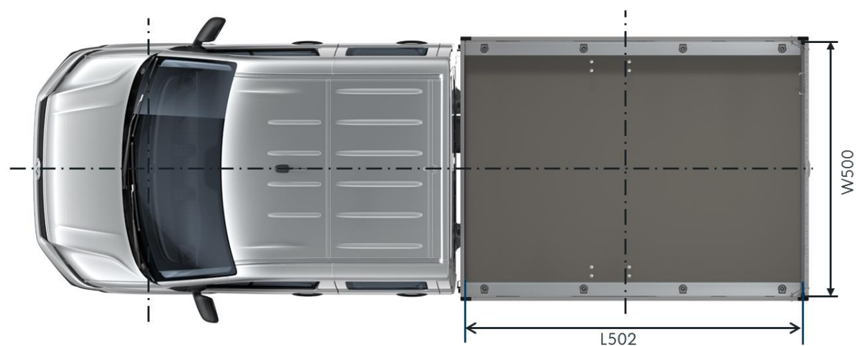
Abb. 2: Fahrzeugmaße Doka – Pritschenwagen/Dachansicht
