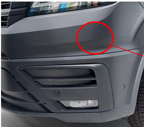
Abb. 3: Position der Radar Sensoren hinter der vorderen Stoßfängerabdeckung
