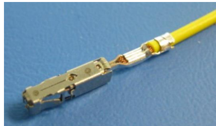
Abb. 6: Gegenstecker „Koppelstelle Vorbereitung Rundumkennleuchten“ mit Einzelleitung und Kontakten
