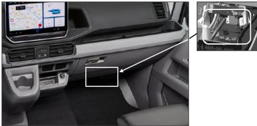
Einbaulage KFG an der unteren Instrumententafel, hinter dem Handschuhfach
