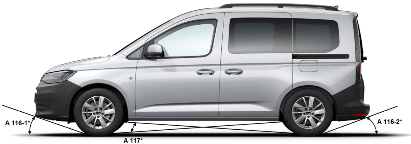
Fig. 2: angolo di attacco e angolo di rampa Caddy
