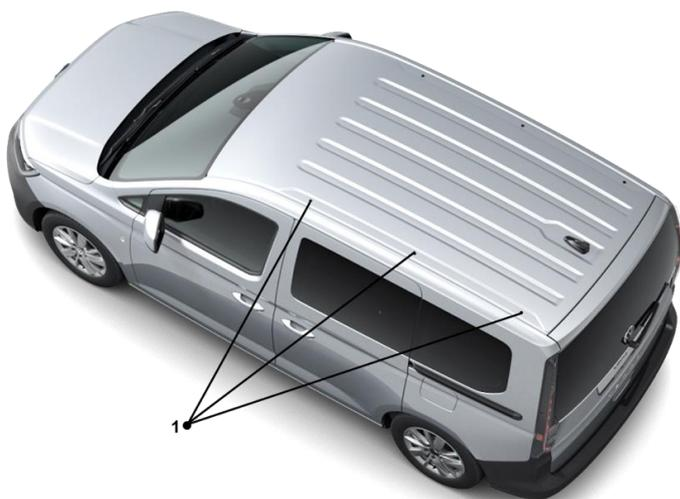
Fig. 1: punti di fissaggio Caddy
