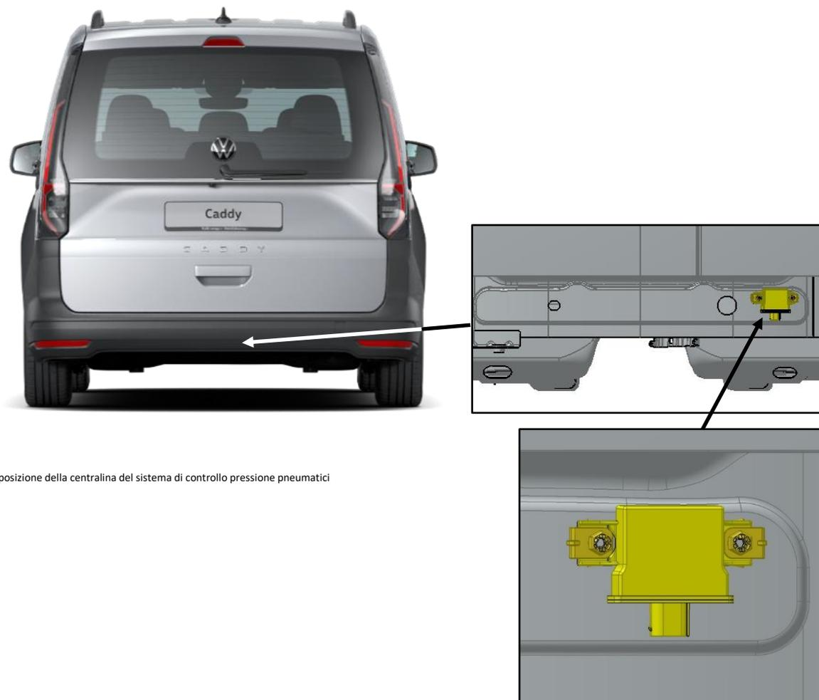
Fig. 1: posizione della centralina del sistema di controllo pressione pneumatici
