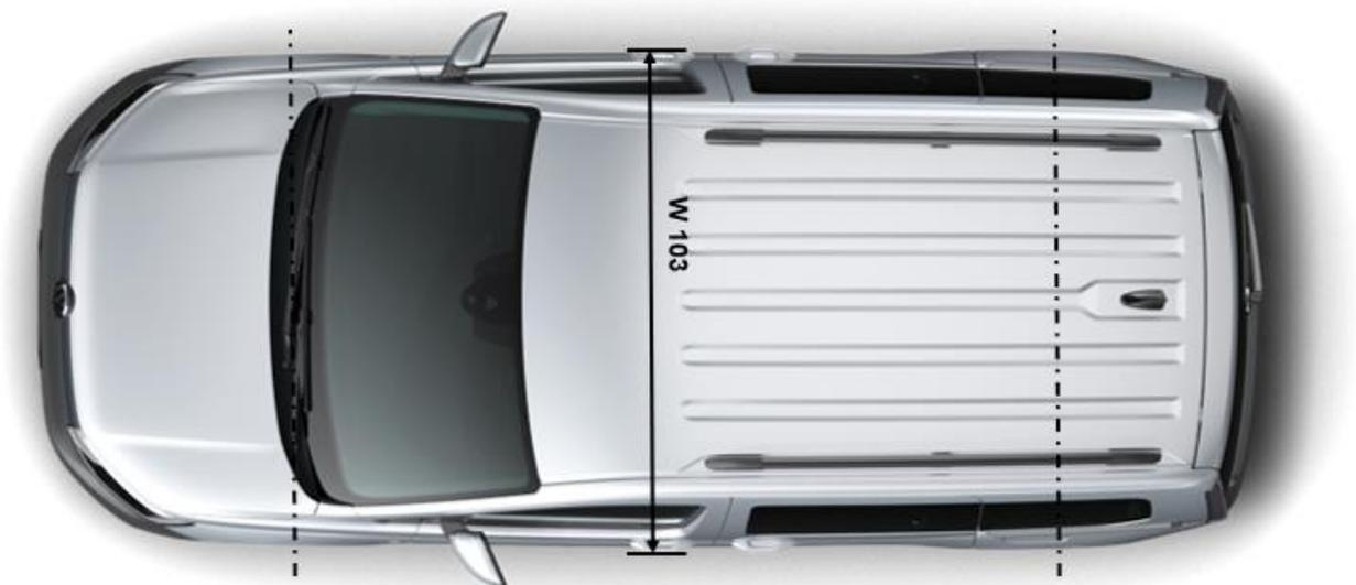
Fig. 2: Dimensioni del veicolo Caddy (secondo la norma DIN70020, parte I)
