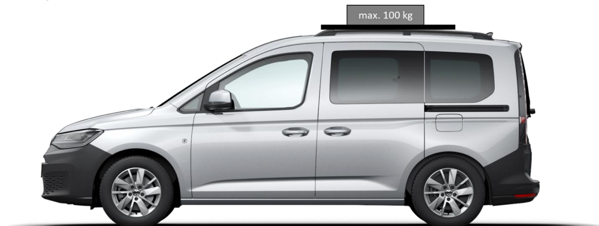
Fig. 1: Carga sobre el techo
