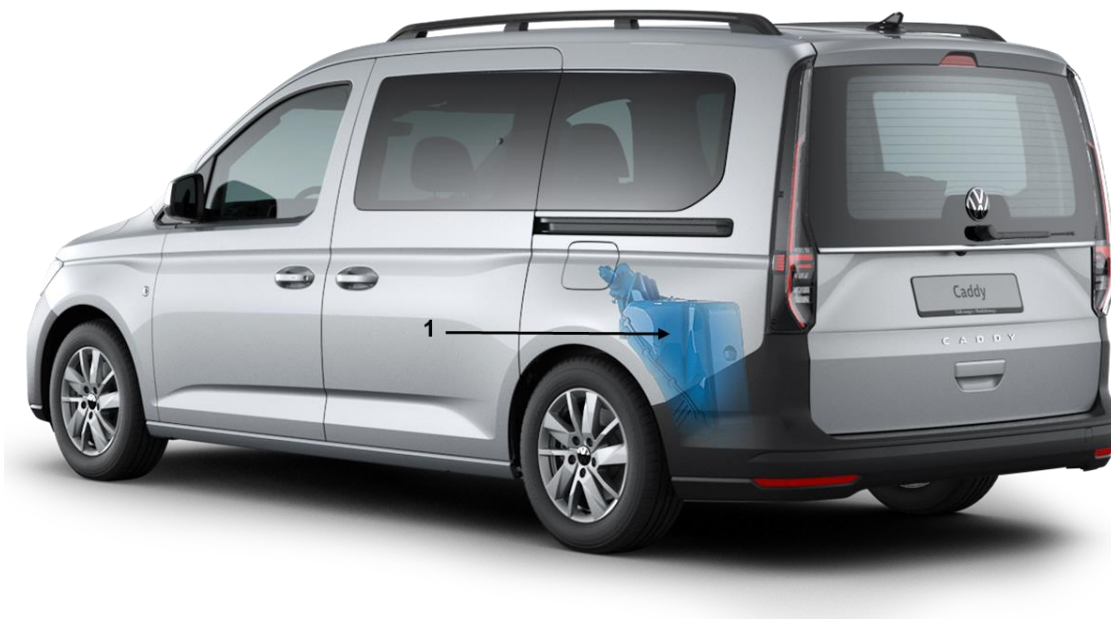
Fig. 1 : Position de montage du réservoir d'agent de réduction dans le véhicule
