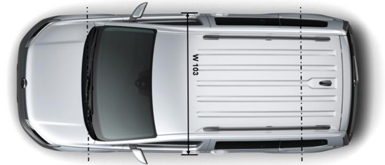
Fig. 2 : cotes du Caddy (selon la norme DIN70020, partie 1)
