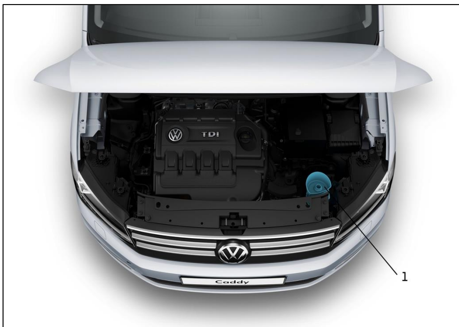
Rys. 2: Otwór do napełniania zbiornika AdBlue® w przedziale silnikowym
