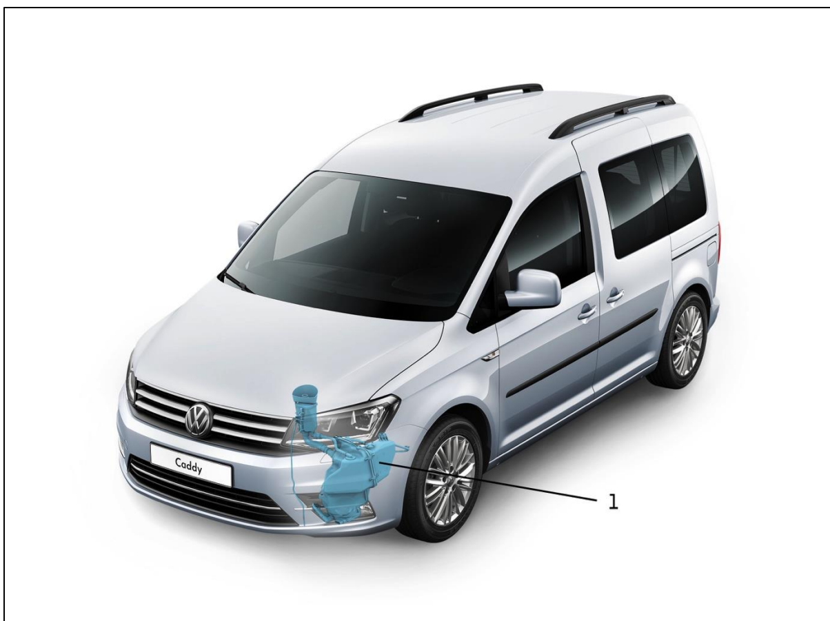
Rys. 1 Położenie montażowe zbiornika AdBlue w pojeździe
