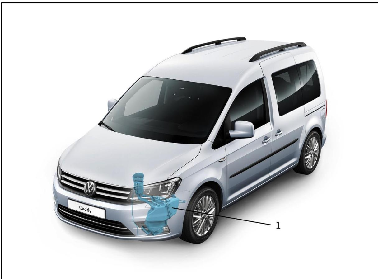
Fig. 1: Ubicación del depósito de AdBlue en el vehículo
