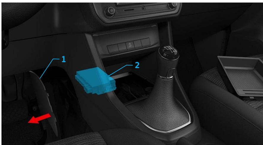
Fig. 4: Interfaz eléctrica para vehículos especiales (núm. PR IS1)
