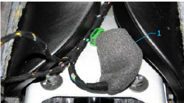
Fig. 3: Interfaz eléctrica para vehículos especiales, vista R (núm. PR IS1 / cable UE1, 2K5.970.372)
