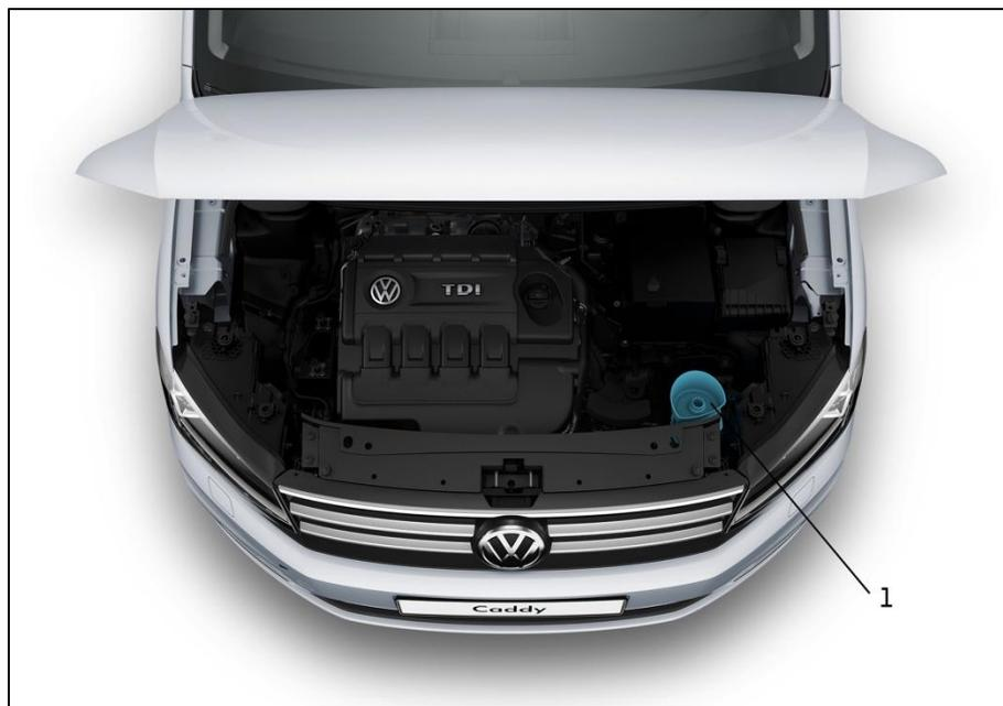
Fig. 2: Orificio de llenado del depósito de AdBlue® en el vano motor
