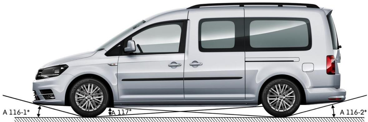
Fig. 2 : Angles d'attaque et de fuite, et angle de crête du Caddy Maxi
