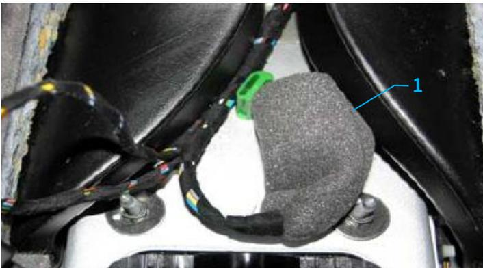
Fig. 3 : interface électrique pour véhicules spéciaux, vue R (n° PR IS1/câble UE1, 2K5.970.372)
