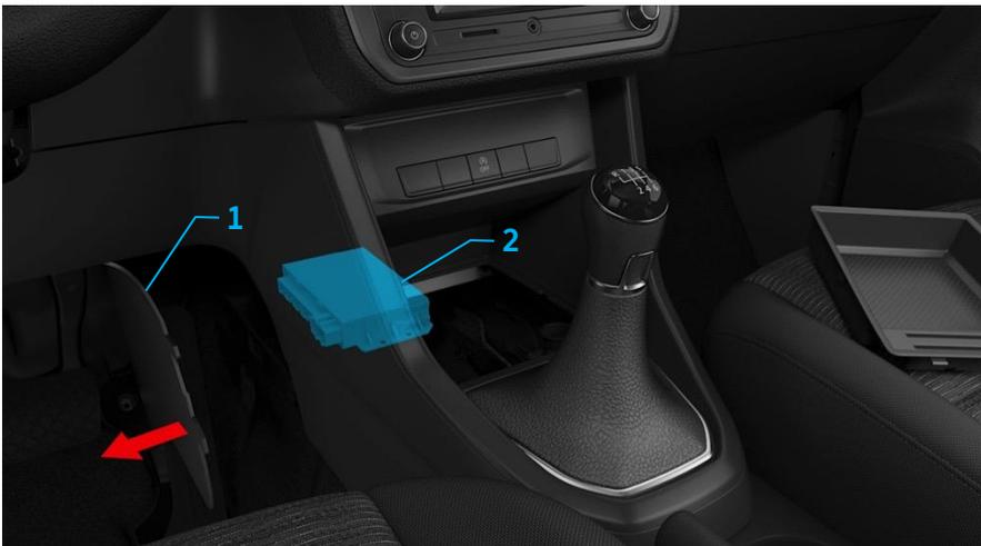
Fig. 4 : interface électrique pour véhicules spéciaux (n° PR IS1)
