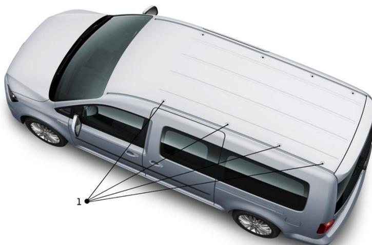
Fig. 2 : points de fixation Caddy Maxi Sur demande, des dessins aux formats CATIA V.4 et TIFF peuvent être mis à la disposition des fabricants de superstructures.
