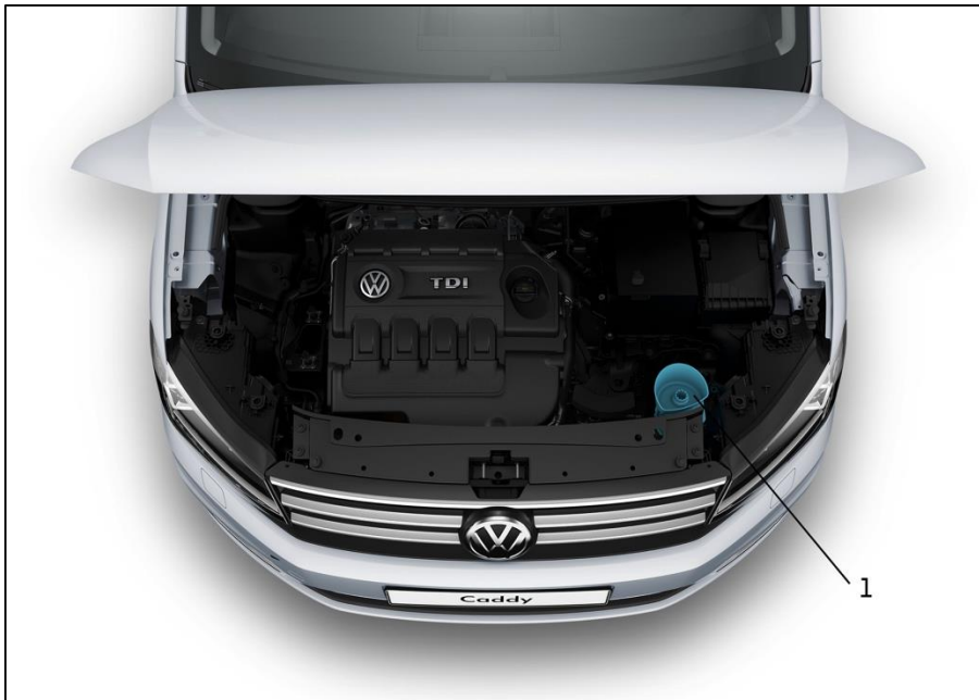
Рис. 2. Расположение заливной горловины бака системы SCR
