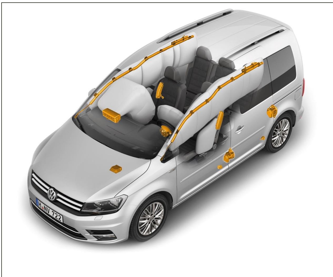
Рис. 3. Зона раскрытия подушек безопасности Caddy
