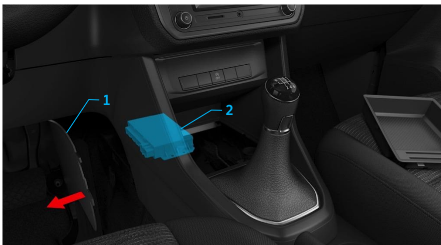
Рис. 4. Электрический интерфейс для спецавтомобилей (код комплектации: IS1)
