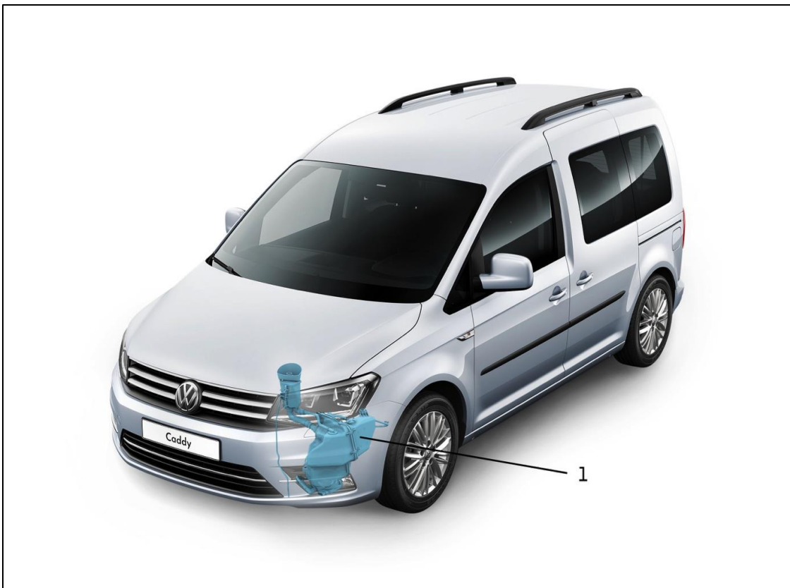
Рис. 1. Место установки бака системы SCR в автомобиле
