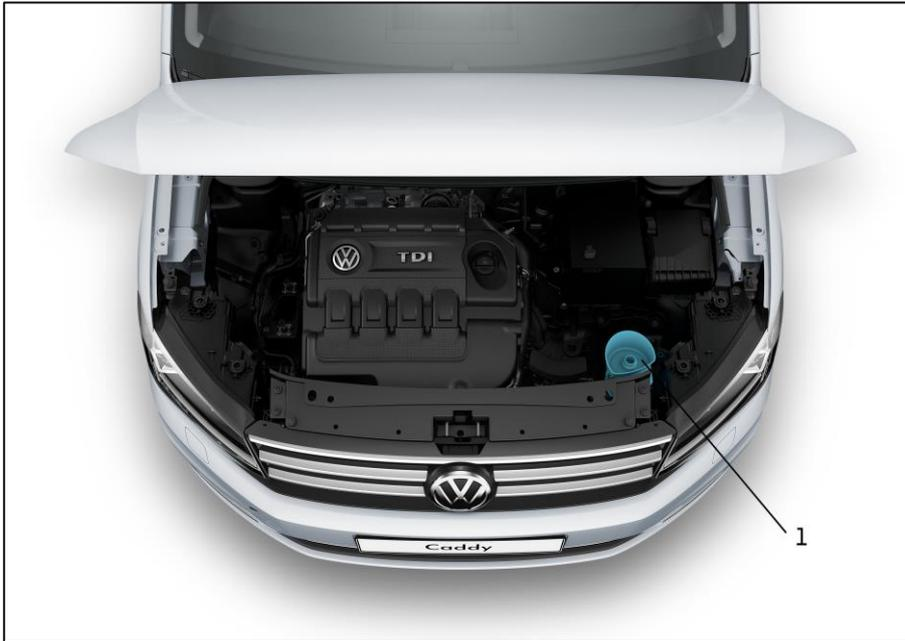
Рис. 2. Заливная горловина бака для жидкости AdBlue® в моторном отсеке.
