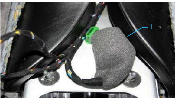
Рис. 3. Электрический интерфейс для спецавтомобилей, вид R (код комплектации IS1/UE1-проводка, 2K5.970.372).
