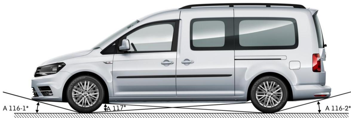
Рис. 2. Угол свеса и продольный угол проходимости Caddy Maxi.
