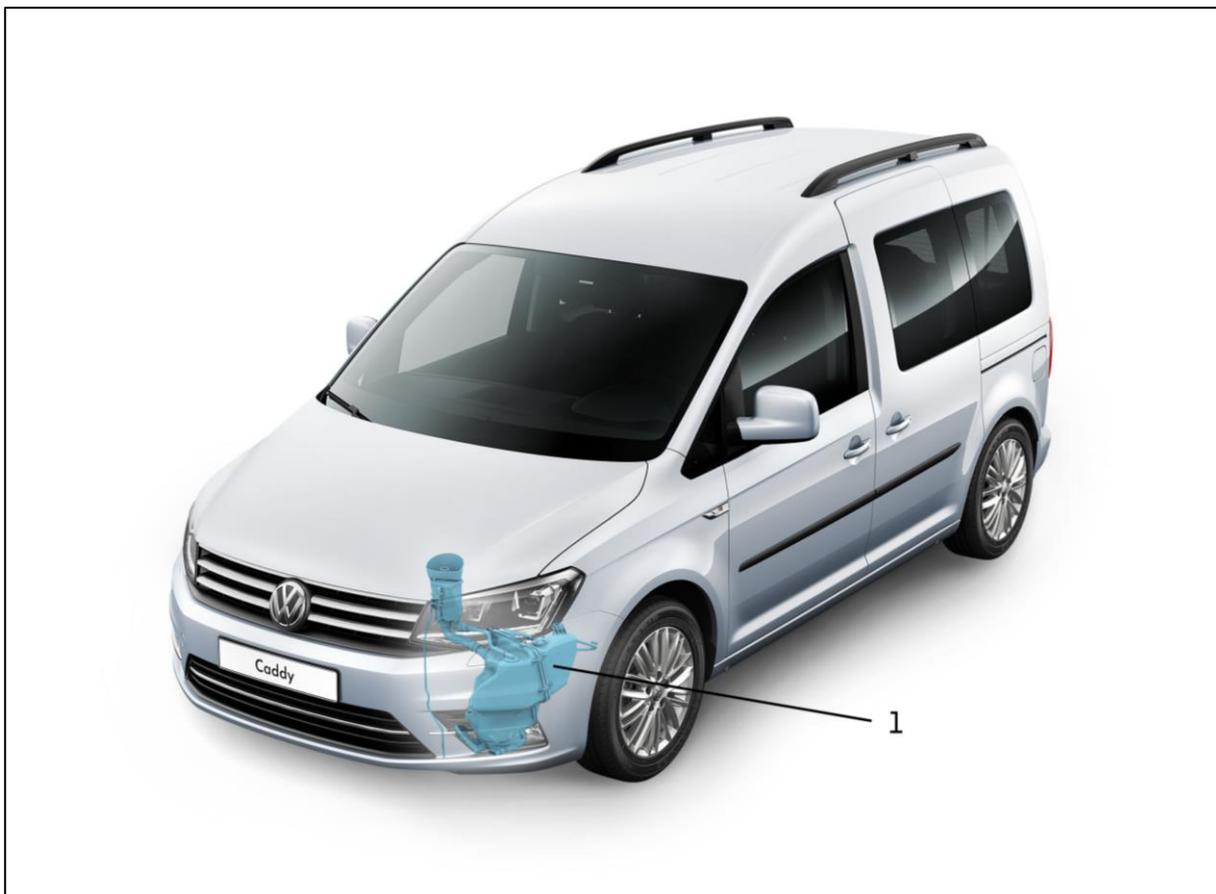
Рис.1. Место установки бака для жидкости AdBlue® в автомобиле.
