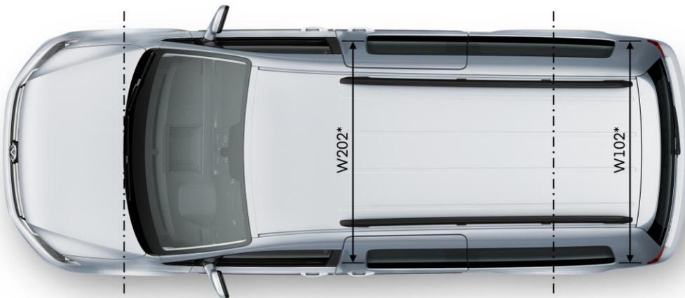
Рис. 3. Габариты Caddy Maxi (согласно стандарту DIN70020, ч. 1).
