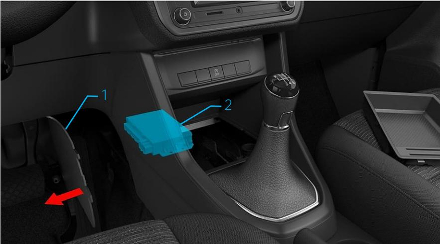
Рис. 4. Электрический интерфейс для спецавтомобилей (код комплектации IS1).
