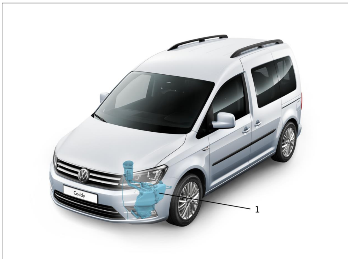
Rys. 1 Położenie montażowe zbiornika AdBlue w pojeździe
