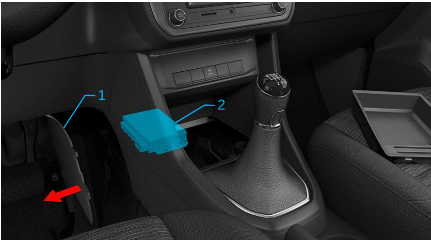
Rys. 4: Złącze elektryczne dla pojazdów specjalnych (nr PR IS1) 1-Okładzina (przestrzeń na nogi, strona kierowcy) 2-Sterownik wielofunkcyjny
