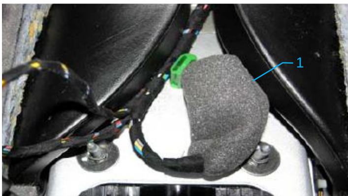
Rys. 3: Złącze elektryczne dla pojazdów specjalnych, widok R (nr PR IS1/UE1 przewód, 2K5.970.372)
