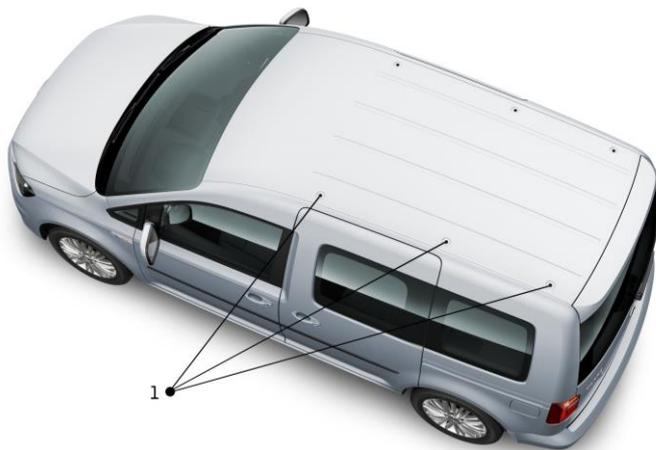
Fig. 1. Punti di fissaggio nel Caddy
