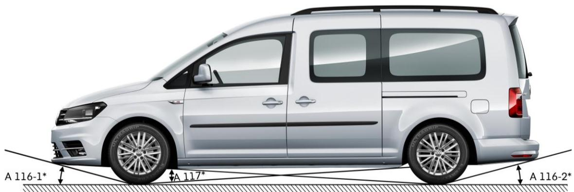
Fig. 2: Angolo di attacco e angolo di rampa Caddy Maxi
