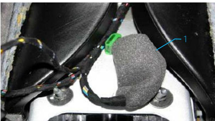
Fig. 3: Interfaccia elettrica per veicoli speciali, Vista R (N. PR. IS1/UE1-Leitung, 2K5.970.372)
