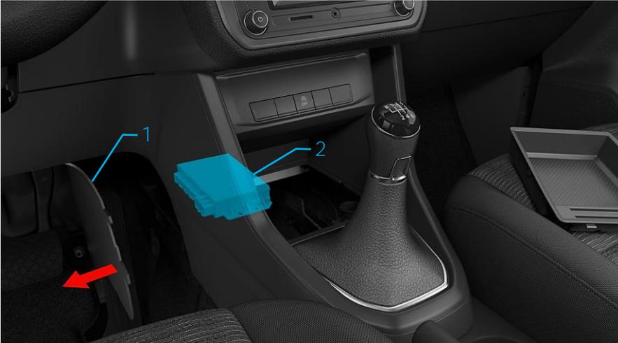
Fig. 4: Interfaccia elettrica per veicoli speciali (N. PR IS1)
