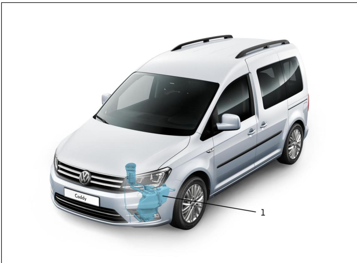
Fig. 1 - Posizione di montaggio del serbatoio dell'AdBlue sul veicolo
