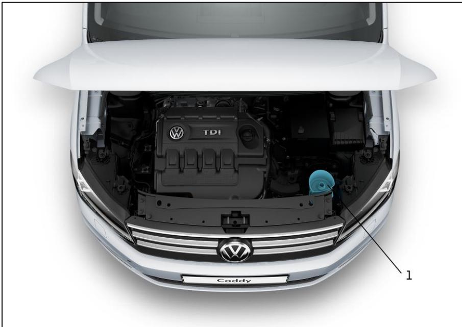
Fig. 2 Orifice de remplissage du réservoir d'AdBlue® dans le compartiment -moteur
