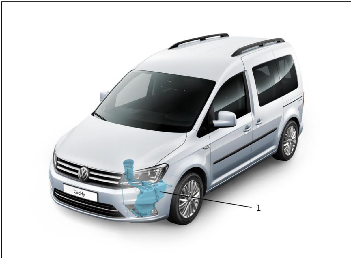
Fig. 1 Position de montage du réservoir d'AdBlue dans le véhicule
