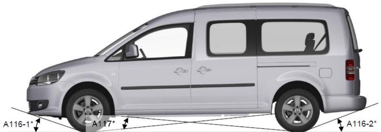
Abb. 2: Überhang- und Rampenwinkel Caddy Maxi
