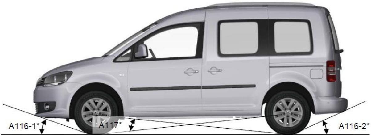
Abb. 1: Überhang- und Rampenwinkel Caddy
