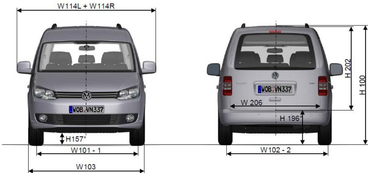
Abb. 2: Fahrzeugmaße Caddy/Caddy Maxi, Ansicht vorn und hinten (gemäß DIN70020, T1)
