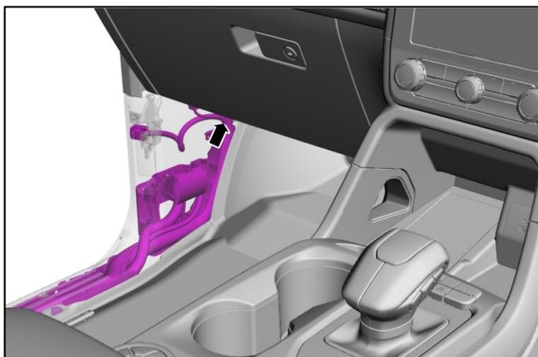
Il segnale del freno del rimorchio può essere disponibile come filo aperto, che si trova sul cablaggio dietro il coperchio del vano piedi a sinistra, nella parte inferiore del montante A, ed è fissato con nastro adesivo.
