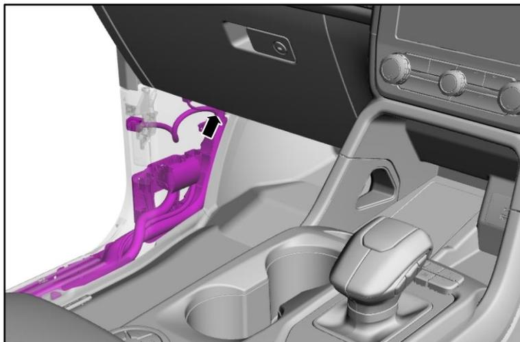
Il segnale della luce di posizione (luce di parcheggio) è disponibile come filo aperto, fissato con nastro adesivo al cablaggio dietro il coperchio del vano piedi sul montante A sinistro.
