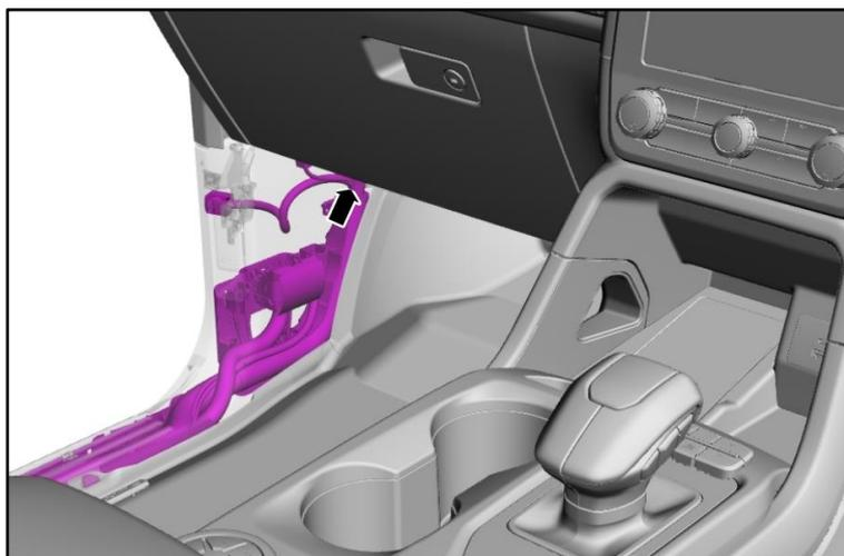
Un signal de feux de position (feu de balisage latéral) est disponible sous forme de fil ouvert fixé au câblage derrière le cache de plancher, sur le montant A gauche arrière avec du ruban adhésif.
