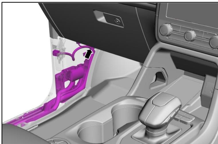
Un signal de frein de remorque peut être disponible sous la forme d'un fil ouvert qui se trouve sur le câblage derrière le cache de plancher, en bas du montant A côté gauche. Ce fil est fixé avec du ruban adhésif.
