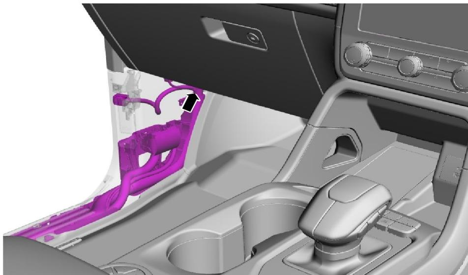
Un signal d'allumage Run-Start est présent sous la forme d'un fil coupé émoussé, fixé sur la dérivation du faisceau de câbles derrière la barre de seuil
