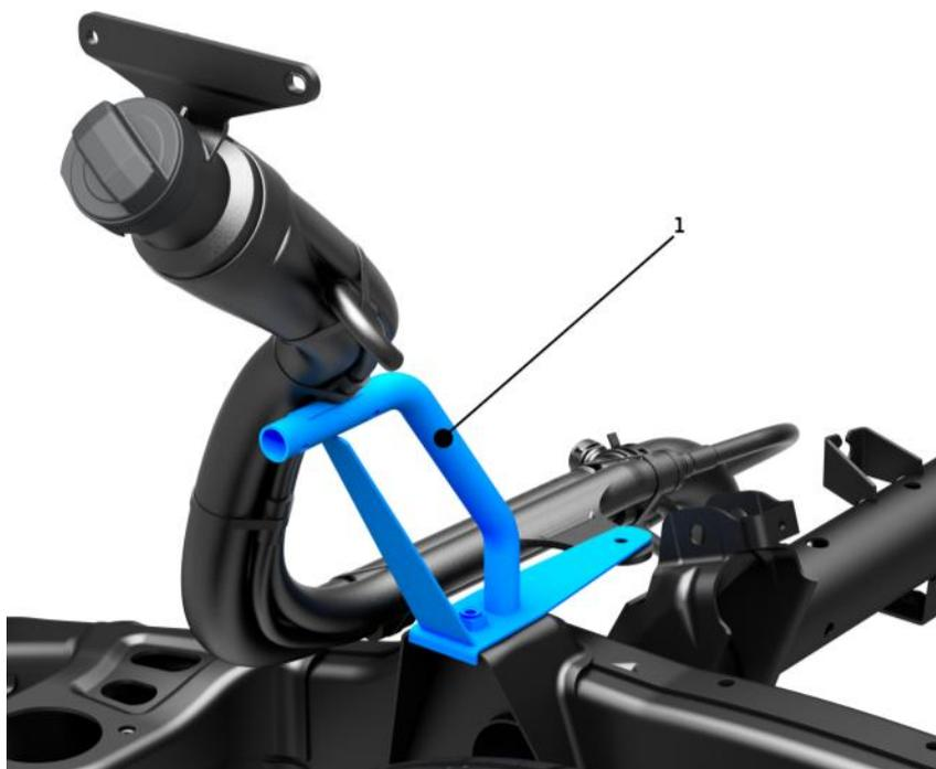
Рис.2: Транспортировочная опора для заливной горловины топливного бака (Amarok без системы SCR)
