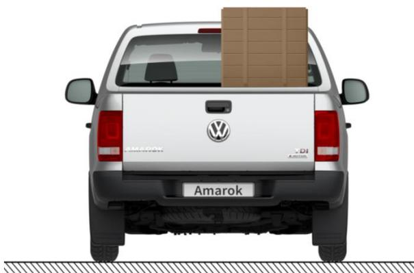
Рис. 1.: Одностороннее распределение нагрузки (вид сзади)
