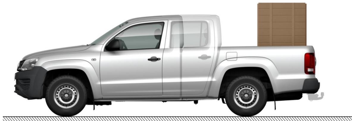
Рис. 2: Одностороннее распределение нагрузки (вид сбоку)
