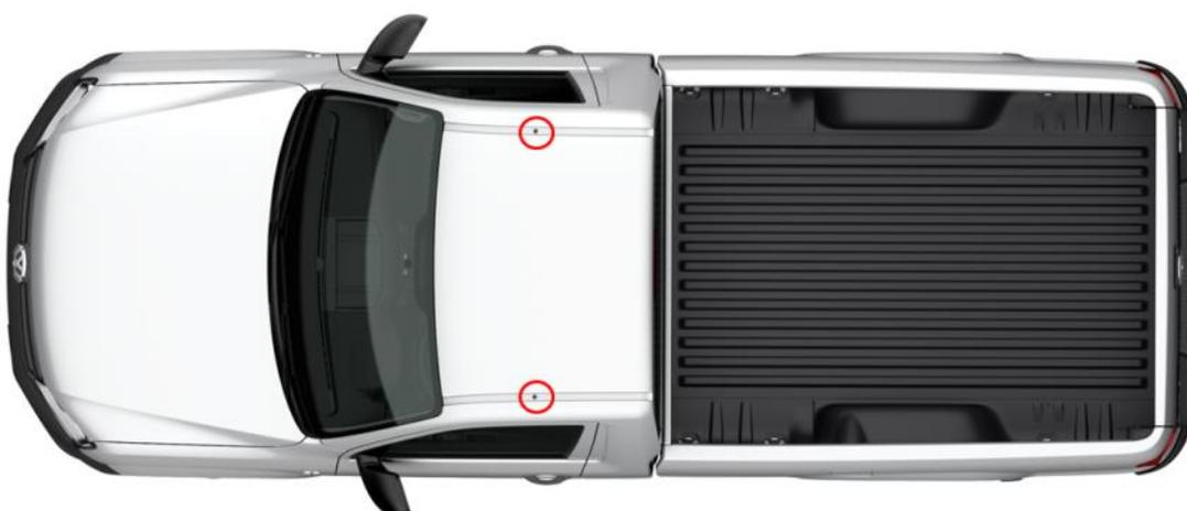
Рис. 2: Точки крепления багажника на крыше Amarok SC (отмечены красным цветом!)
