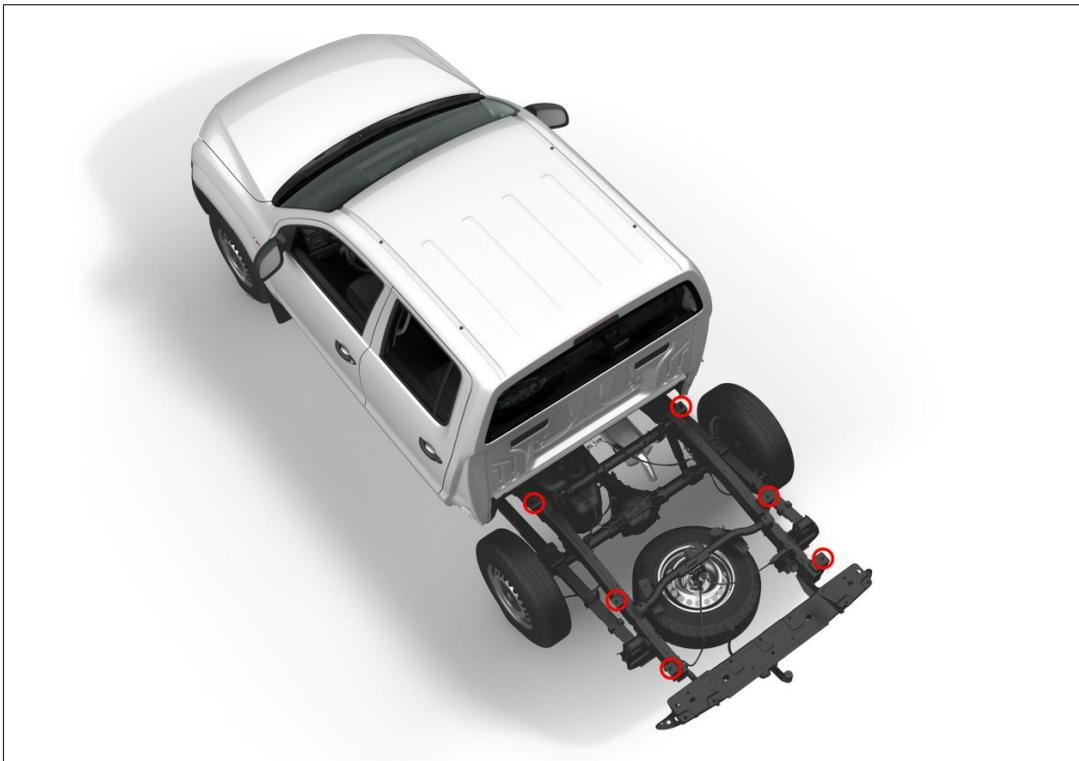
Рис. 1: Amarok Double Cab – консоли крепления Cargobox (отмечены красным!), условное изображение, без транспортировочной рамы и бака SCR.
