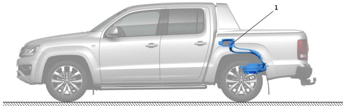
Рис. 4. Заливные компоненты системы SCR
