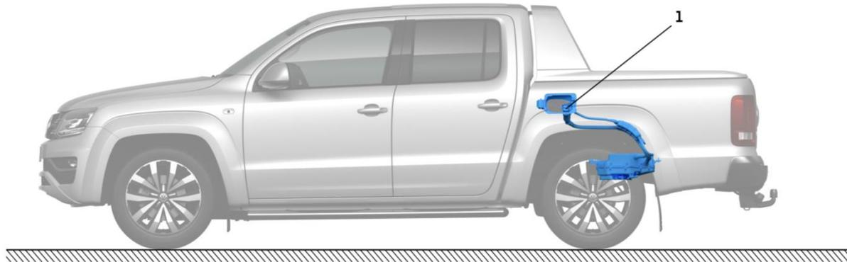
Abb.4: Befüllöffnung des AdBlue® Tanks
