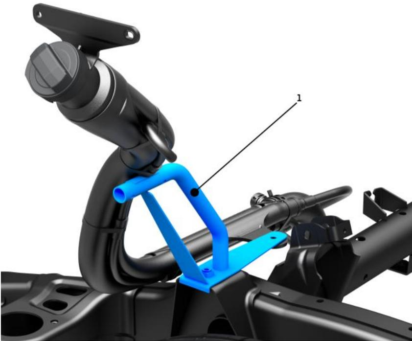
Abb.2: Transportstütze für das Tankeinfüllrohr (Amarok ohne SCR-System)
