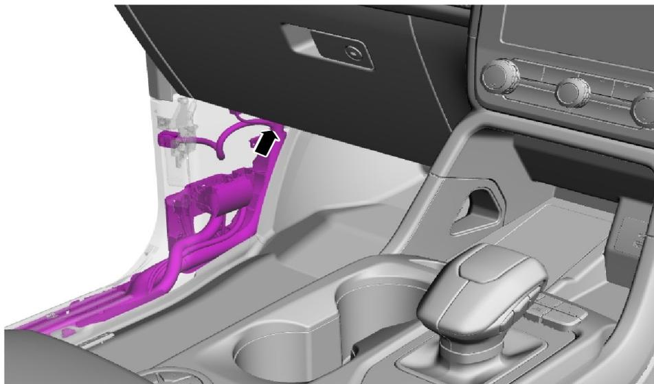
Ein Run-Start-/ Zündsignal ist als stumpf geschnittener Draht vorhanden und am Kabelbaumzweig hinter der Trittleiste der A-Säule links befestigt. Der Draht ist weiß / grün gefärbt und hat eine Stromstärke von 10 Ampere.
