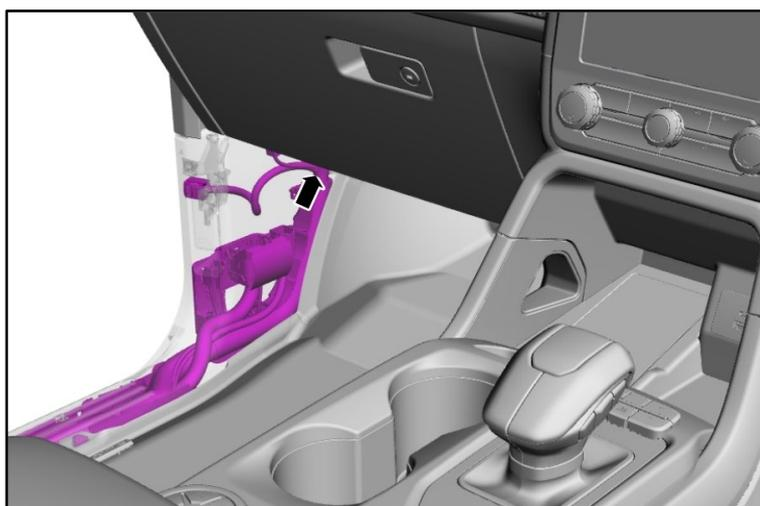
Ein Anhängerbremsensignal kann als offener Draht verfügbar sein, der sich am Kabelstrang hinter der Fußraumabdeckung links an der A-Säule unten befindet und mit Klebeband befestigt ist.
