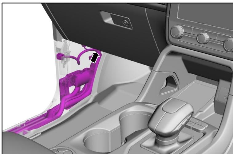
Ein Positionsleuchten (Standleuchten)-Signal ist als offener Draht verfügbar, der am Kabelstrang hinter der Fußraumabdeckung an der LHS A-Säule mit Klebeband befestigt ist.
