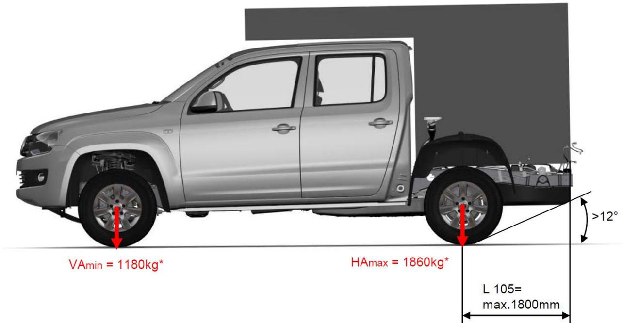
Fig. 1: Allungamento massimo dello sbalzo (telaio heavy duty)
