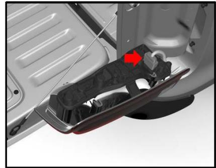
Fig. 4.1.1.1: Smontaggio dei fanali posteriori (fig.1, 2 e 3)
