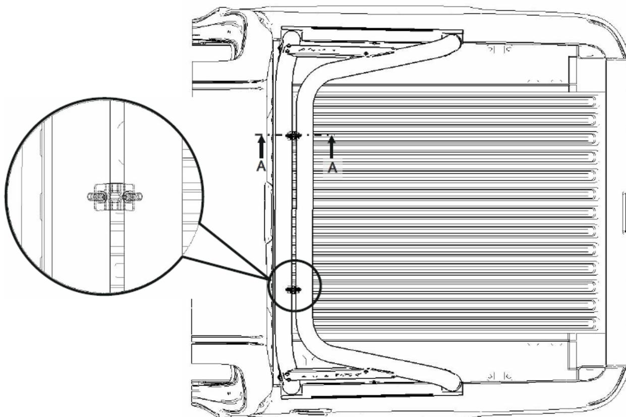
Fig. 1: esempio di Styling Bar a doppio tubo (vista dall'alto)
