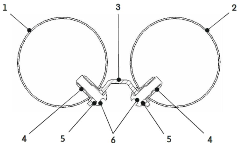
Fig. 2: esempio di fissaggio dei tubi anteriori e posteriori (sezione A-A)
