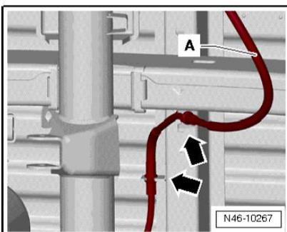
Fig. 4.1.2.1: Distacco del tirante del freno a mano
