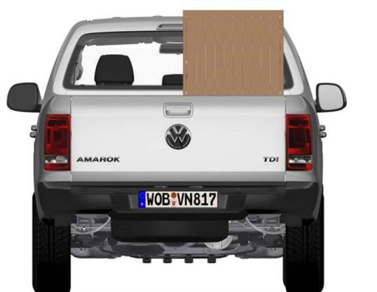
Fig. 1.: Distribuzione non uniforme del peso (vista posteriore)
