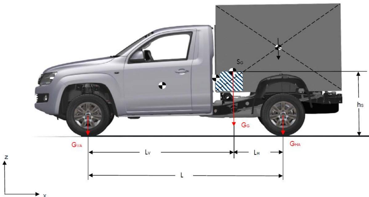
Fig. 1: Calcolo della posizione del baricentro complessivo del veicolo in direzione x
