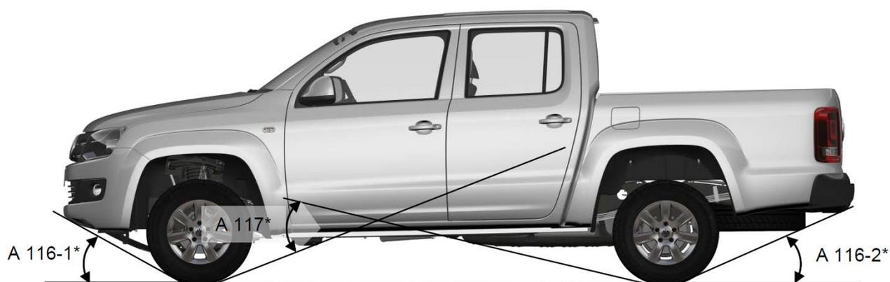
Fig. 1: Angolo di attacco e angolo di rampa Amarok DC (cabina doppia)
