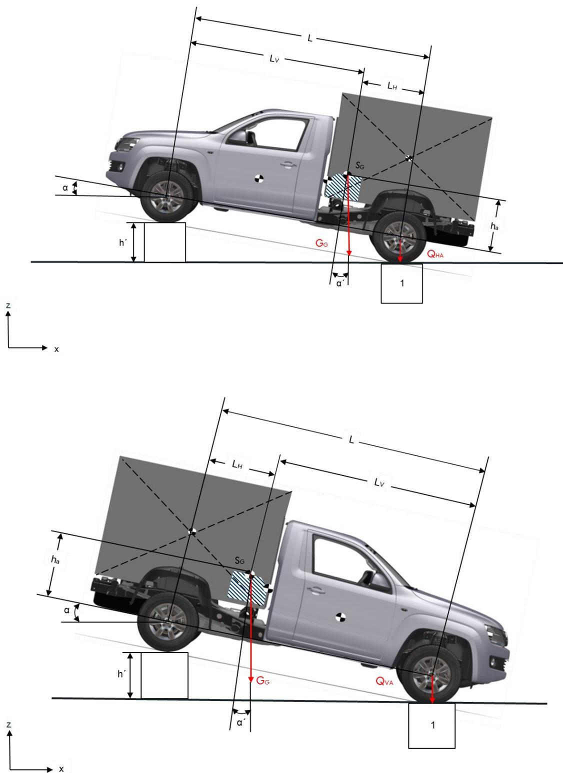
Fig. 2: Calcolo della posizione del baricentro complessivo del veicolo in direzione z
