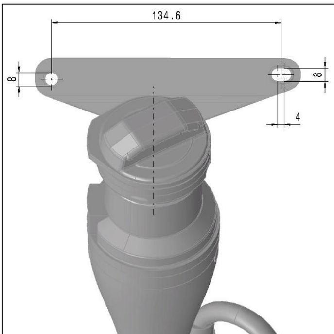
Fig. 4.1.7.2: Bocchettone del serbatoio con flangia di fissaggio di serie
