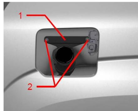
Fig. 4.1.4.1: Rimozione del bocchettone di immissione del carburante
