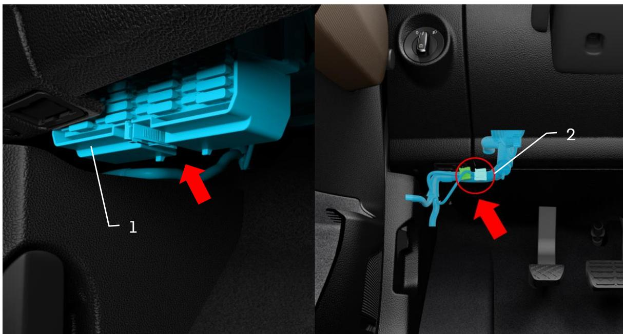
Fig. 2: Posizione dell'interfaccia elettrica UF1 (vano piedi lato conducente, dietro il portafusibili)
