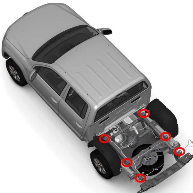
Fig. 4.3.1: Amarok cabina doppia: elementi aggettanti per il fissaggio del cassone (evidenziati in rosso!)
