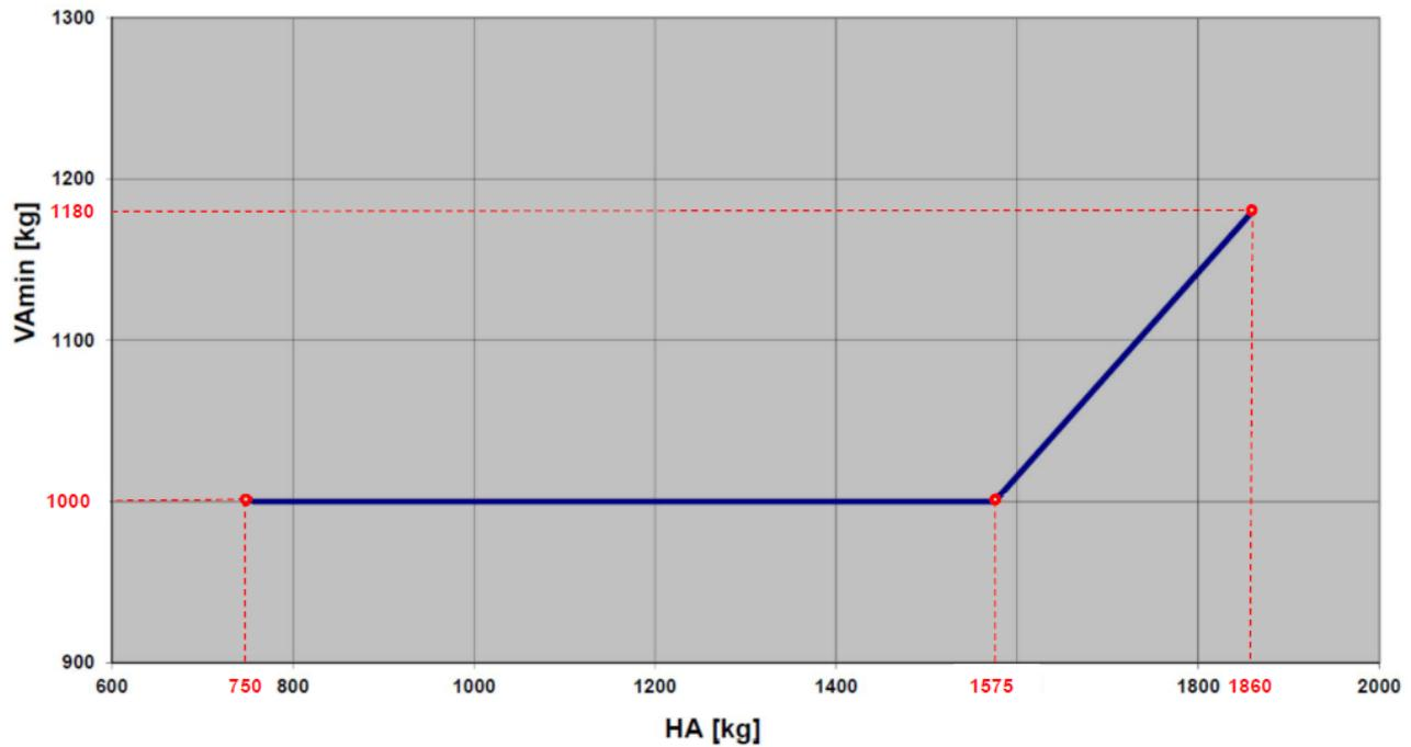
Fig. 2.: Carico minimo sull'asse anteriore Amarok (telaio heavy duty)
