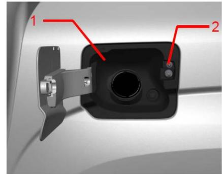
Fig. 4.1.4.2: Rimozione dell'unità dello sportellino del serbatoio
