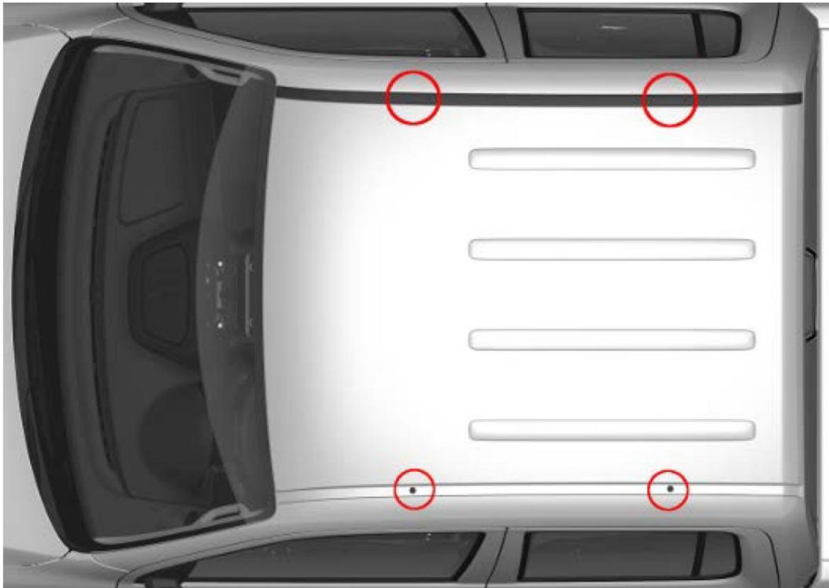
Abb. 1 : Anschraubpunkte Dachgepäckträger Amarok-DC (rot markiert!)
