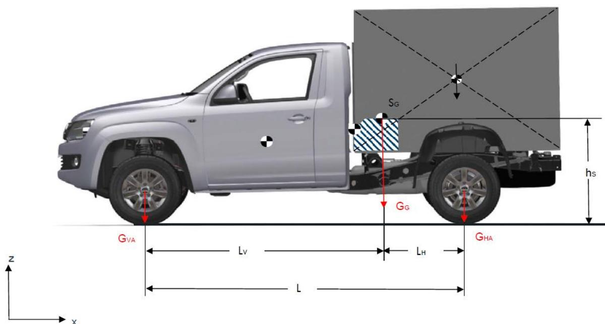
Abb. 1: Ermittlung der Lage des Fahrzeuggesamtsschwerpunktes in x-Richtung
