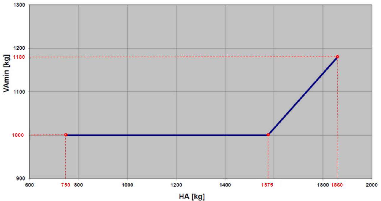
Abb. 2.: Mindest Vorderachslast Amarok (Heavy Duty Fahrwerk)
