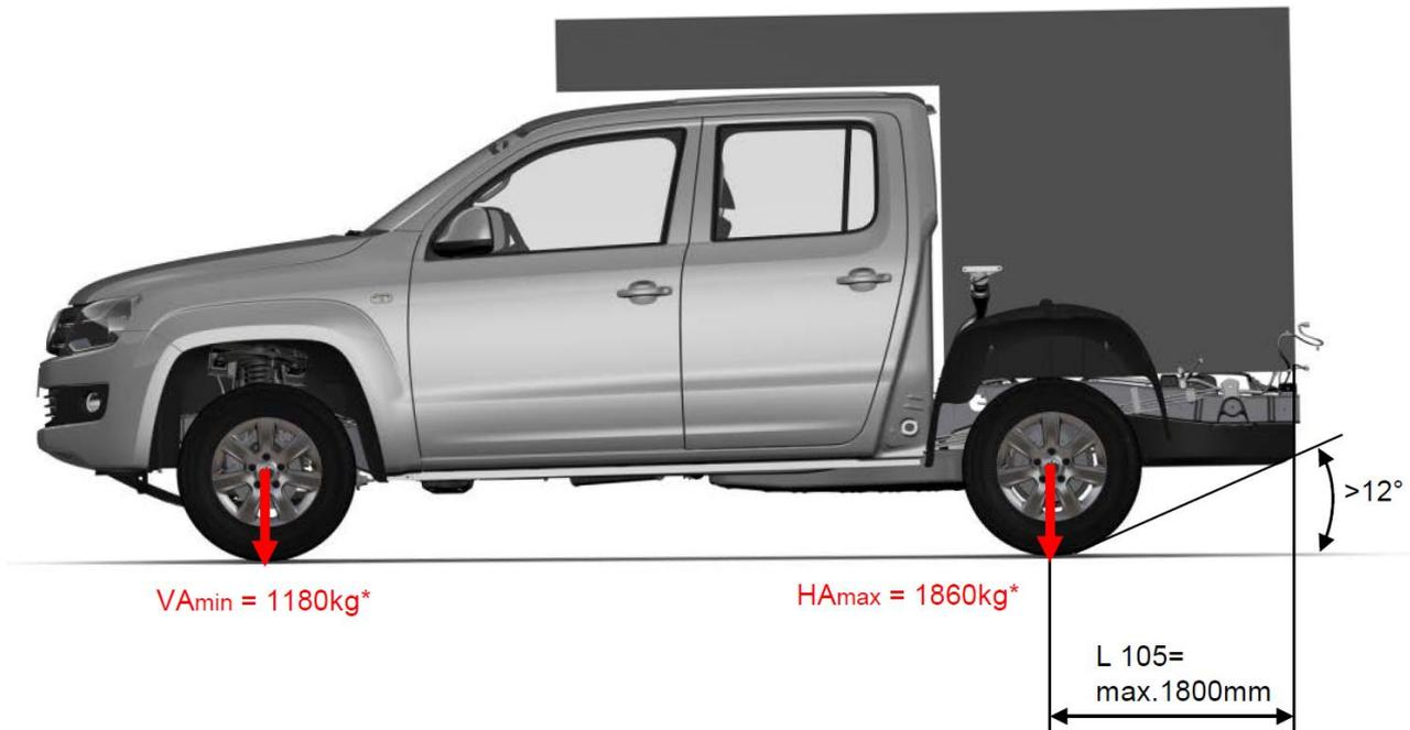
Abb. 1.: Maximal zul. Überhangverlängerung (Heavy Duty Fahrwerk)
