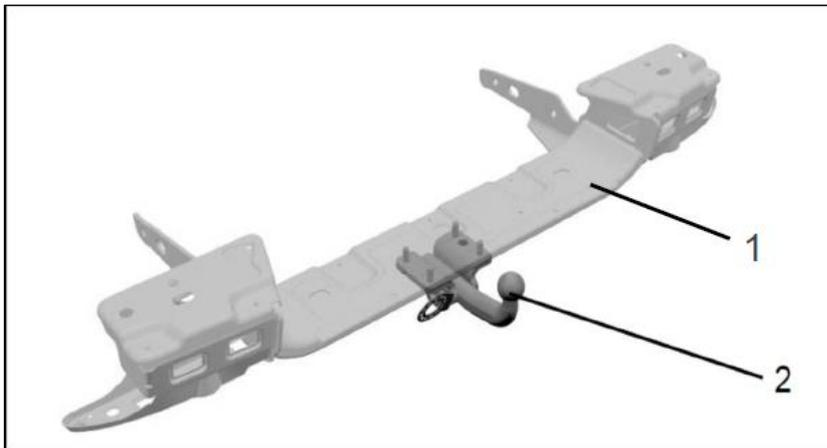
Abb. 1 : 1 = Stoßfänger 2= Kugelkopf
