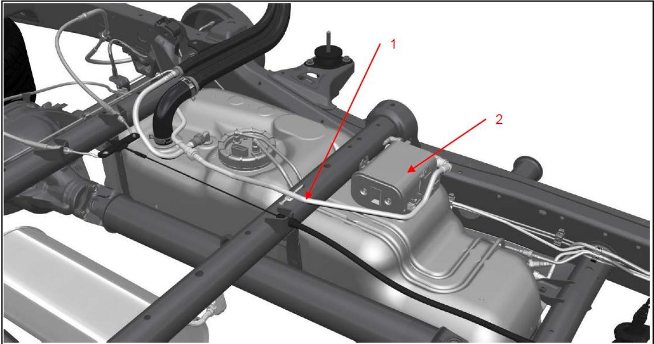
Abb. 2: Benzin-Einfüllrohr
