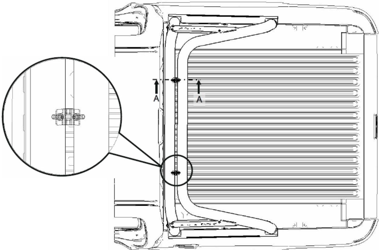
Abb. 1: Beispiel für Styling-Bar in Doppelrohrausführung (Draufsicht)
