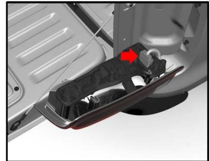
Abb. 4.1.1.1: Ausbau der Schlussleuchten (Abb.1, 2 und 3)
